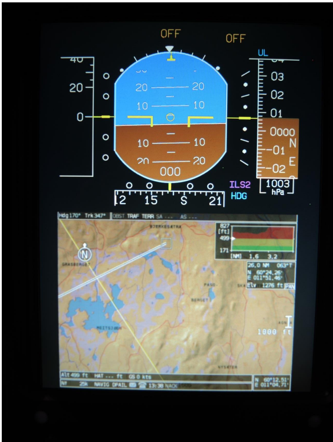
Figur 8: Eksempel på kombinert visning på redningsmannens skjerm med flygeinstrumenter øverst og "moving map" nederst. Foto: SHT
