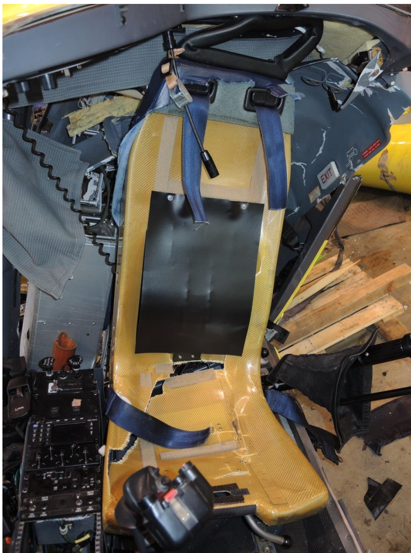
Figur 18: Setet til redningsmannen etter at seteputer og polstring er fjernet. Både seteryggen og seteplaten har revnet. Øverst sees nakkestøtten som er klemt ned til venstre av cockpit-taket. Setebeltene er kuttet i forbindelse med redningsaksjonen. Foto: SHT
