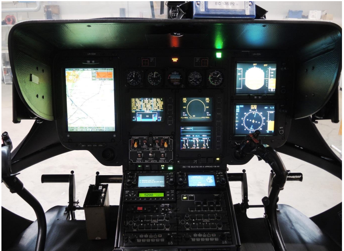
Figur 7: Cockpit på en av Luftambulansens EC 135. Den store skjermen til venstre opereres av rekningsmannen. Han kan velge å vise kartbilde fra EURONAV på hele skjermen som vist på bildet, eller dele skjermen i to deler og få samme visning som for flygeren til høyre. En tredje mulighet er at skjermen til venstre viser flygeinstrumenter på den øvre halvdel og kart på den nedre halvdel av skjermen (se figur 8). Foto: SHT
