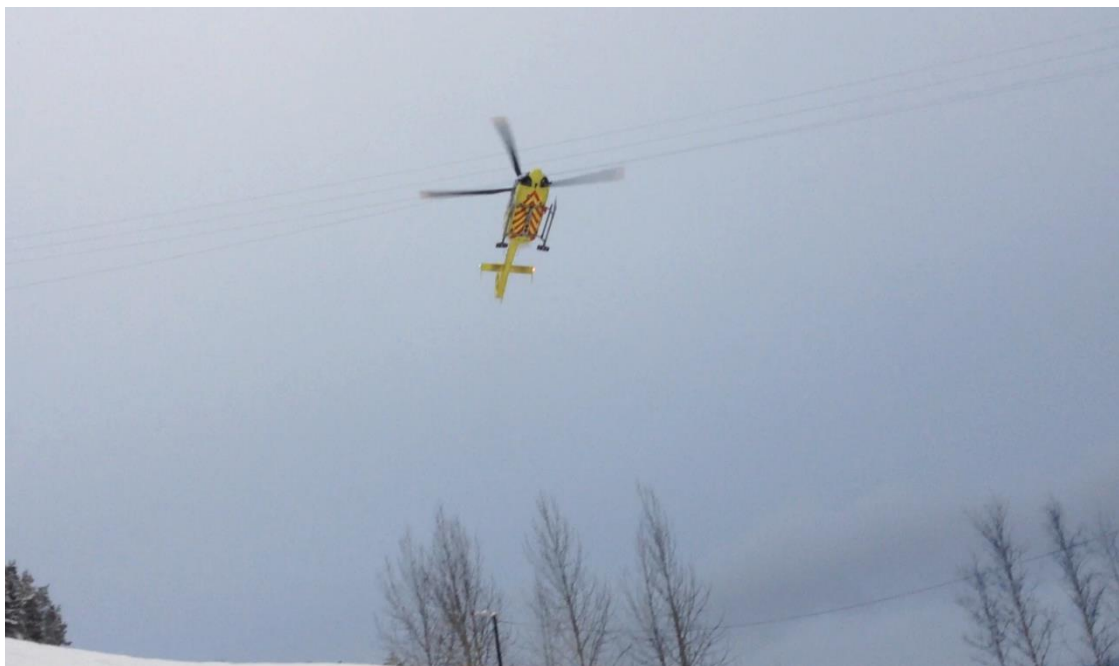
Figur 2: Helikopteret har truffet jordingslinjen med "wire cutter" og dratt ledningen i flyretningen. Hovedrotoren roterer under de strømførende ledningene. Ledningen mellom gatelysene langs påkjøringsrampen til E 16 sees nederst på bildet. Foto: Stillbilde fra privat videofilm
