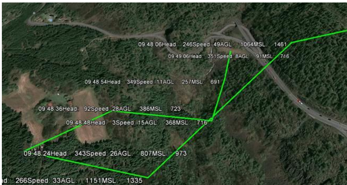
Figur 12: Innflygingen gjengitt med tid, retning (Head) hastighet (Speed), høyde over bakken (AGL) og høyde over havet (MSL) Kartkilde: NLA/Google Earth
