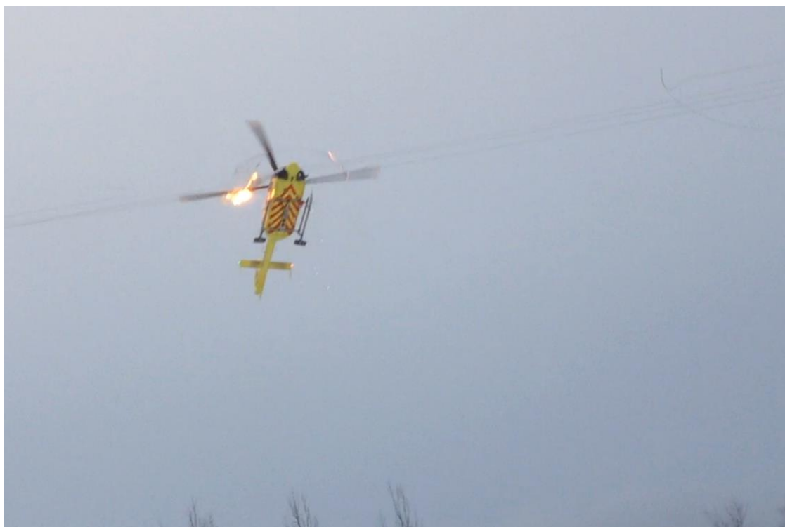
Figur 3: Rett etter at hovedrotoren har kuttet en av de strømførende ledningene. En av ledningsendene er på vei ut av bildet til høyre. En annen del av ledningen er i ferd med å bli slynget rundt rotoren. Foto: Stillbilde fra privat videofilm
