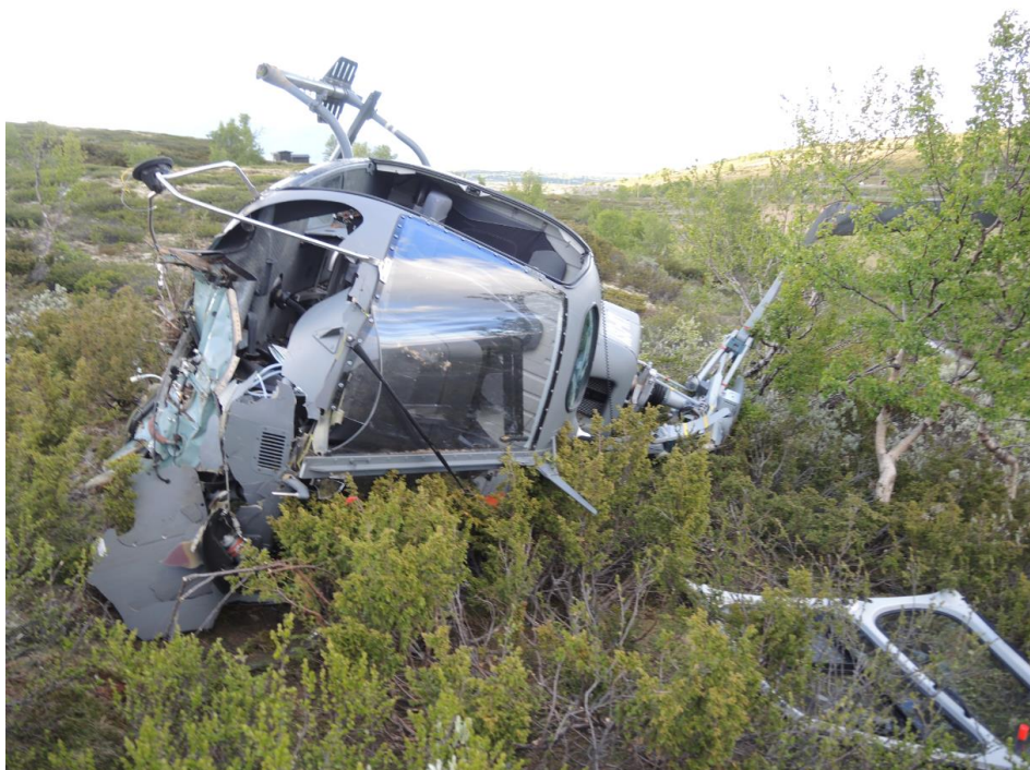
Figur 16: Skader i neseseksjon. Foto: SHT
