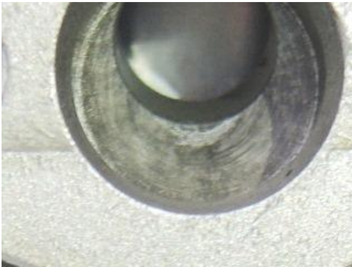
Figur 21: Merke i innløp til varmeveksler. Foto: SHT
