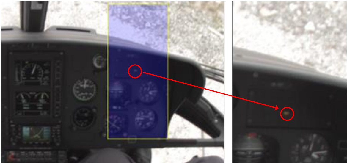
Figur 1: Første dataframe fra Appareo Vision 1000 som viser tent gult "GOV"-lys. Kilde: Pegasus Helicopter
