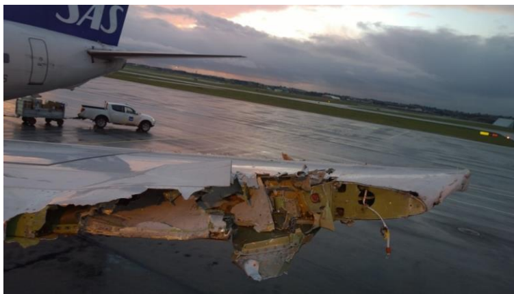
Figur 8: Skader på venstre vinge. Foto: SAS
