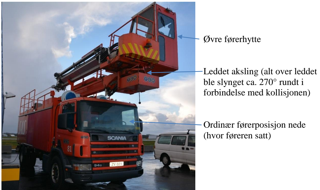
Figur 2: Tilsvarende avisingsbil som den som var involvert i ulykken. Flyets vinge traff rekkverket rundt øvre førerhytte. Foto: SHT
