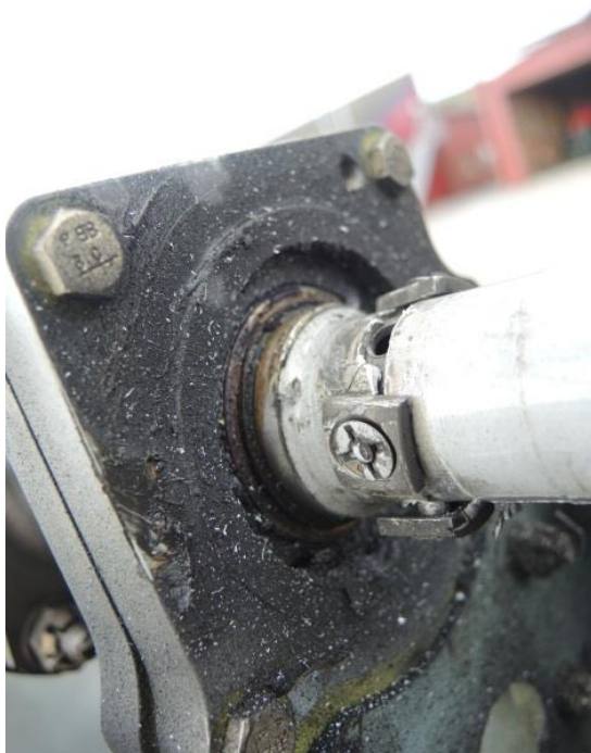
Figur 4: Brudd i naglesammenføyningen på mellomseksjon av halerotorakselen til LN-ORR. Foto: SHT
