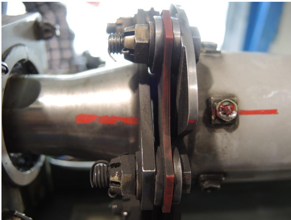
Figur 6: Antydning til separasjon i den fleksible koblingen bak lager nr. 1. Foto: BEA
