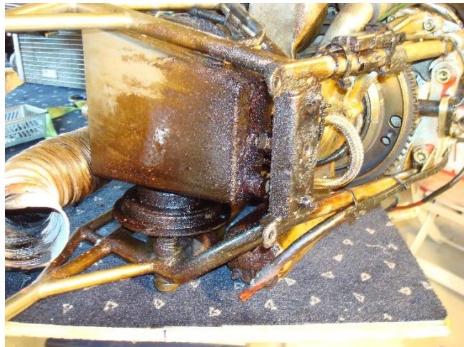
Figur 6: Brann-/varmeskader på oljetank og området ved bakre motorfeste. Foto: S/NLF
