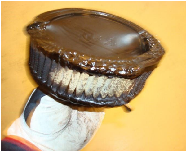
Figur 5: Brann-/varmeskader på luftfilteret. Endeveggen på filteret er buet innover. Foto: S/NLF
