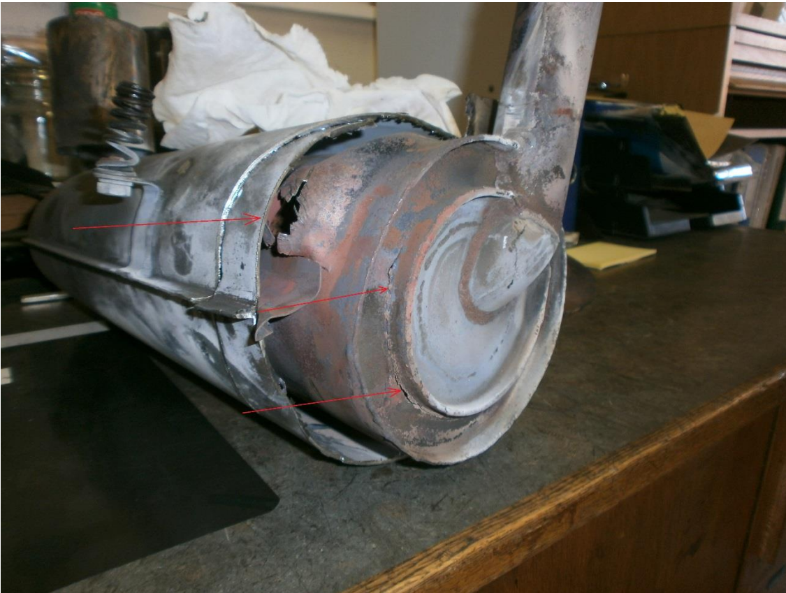
Figur 4: Eksospotten delvis oppskåret. Det ytre varmeskjoldet ble først demontert. På bildet sees tydelig det omsluttende rommet hvor den innvendige kjølelufta passerer. Piler angir sprekker i det innerste elementet. Foto: S/NLF
