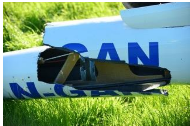
Figur 2: Skadene på halebommen. Foto: Privat
