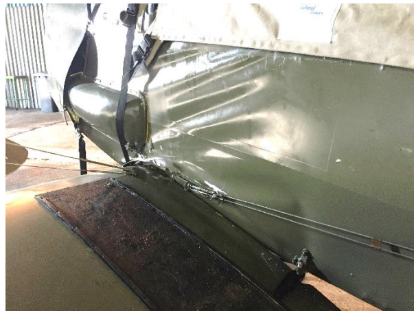
Figur 1: Skader i området rundt innfesting av venstre hovedunderstell. Foto: SHT
