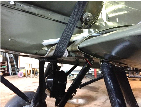
Figur 1: Skader i området rundt innfesting av venstre hovedunderstell. Foto: SHT
