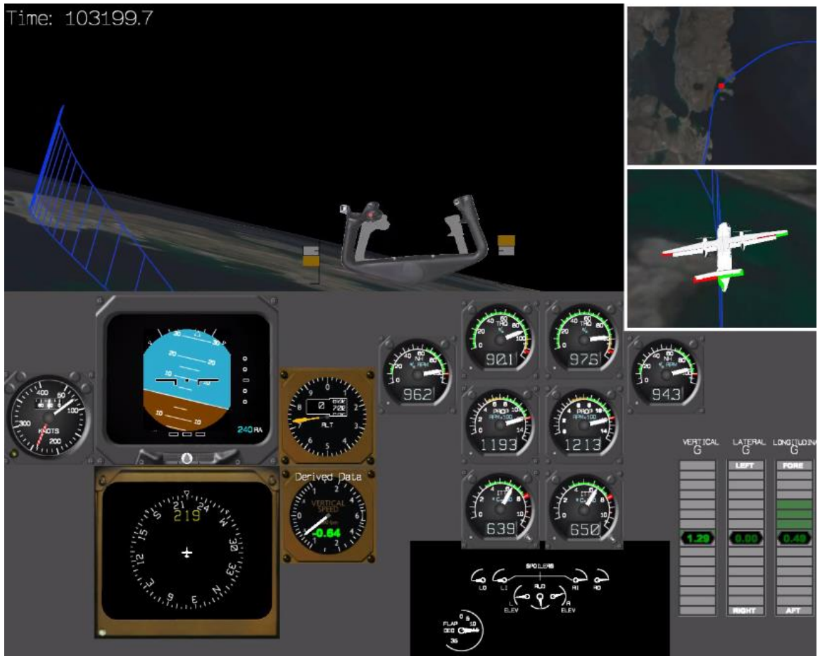
Figur 10: Stillbilde fra animasjon av hendelsen med LN-WIU som viser situasjonen idet motor-kraften nærmer seg «Full power», like før stikka føres markant forover. Merk: Animasjonen er basert på data fra FDR. Omgivelser, sikt og vindforhold er ikke representative for den aktuelle hendelsen, og indikasjonene på høydemåler og stigefartsmåler samsvarer ikke med det som ble vist i cockpit. Skjermdump: SHT
