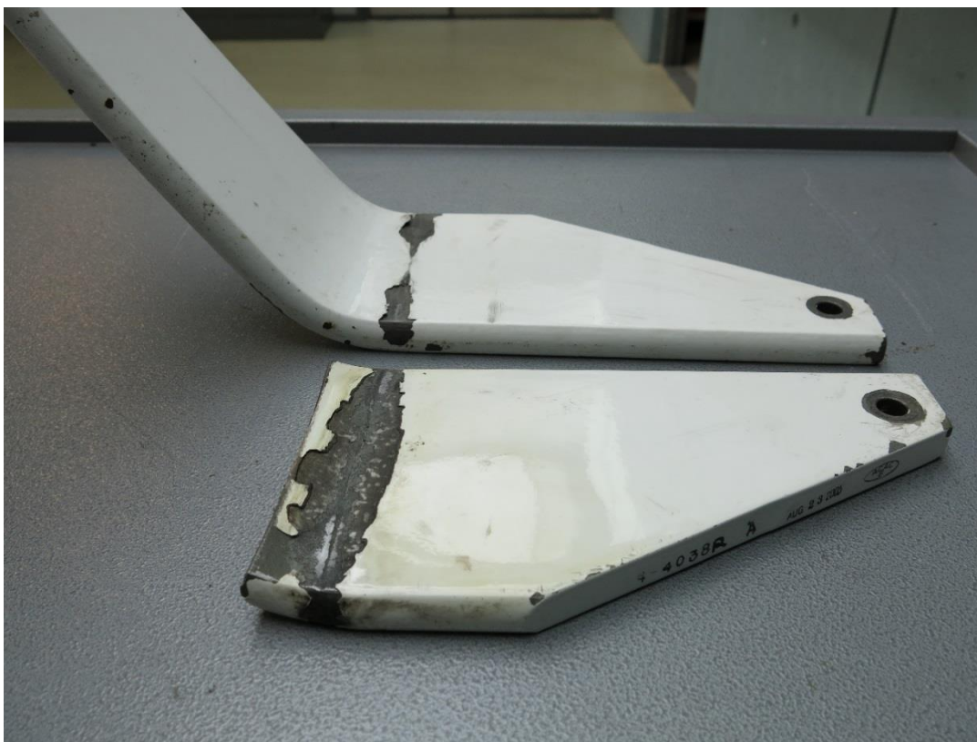
Figur 3: Venstre og høyre understellslegg, der den høyre er knekt ved innfestningen til flyskroget. Foto: SHT
