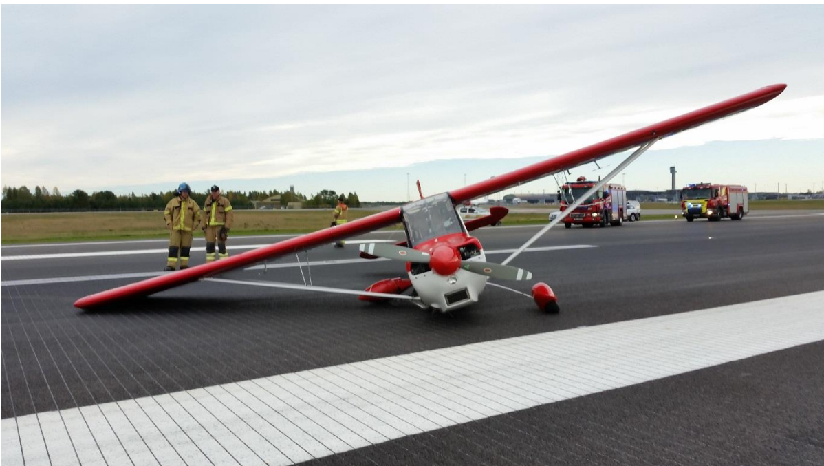
Figur 1: LN-LCU, etter landing på rullebane 19R Oslo lufthavn Gardermoen, med knekt høyre understellslegg. Foto: Oslo lufthavn Gardermoen, Brann og redningstjenesten
