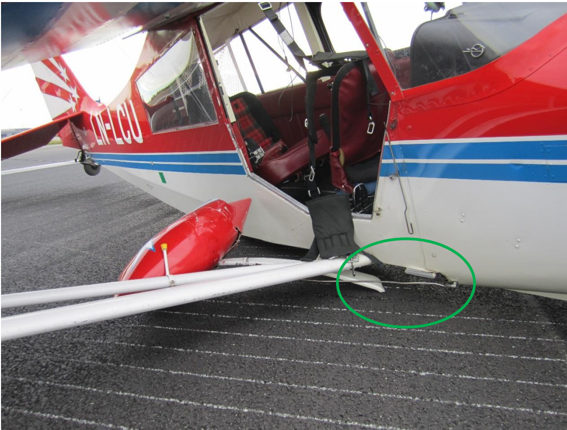
Figur 2: Den knekte høyre understellsleggen, samt bremsørøret, som understellsleggen hang i under flyturen fra Reinsvoll til Gardermoen. Foto: Oslo lufthavn Gardermoen, Brann og redningstjenesten
