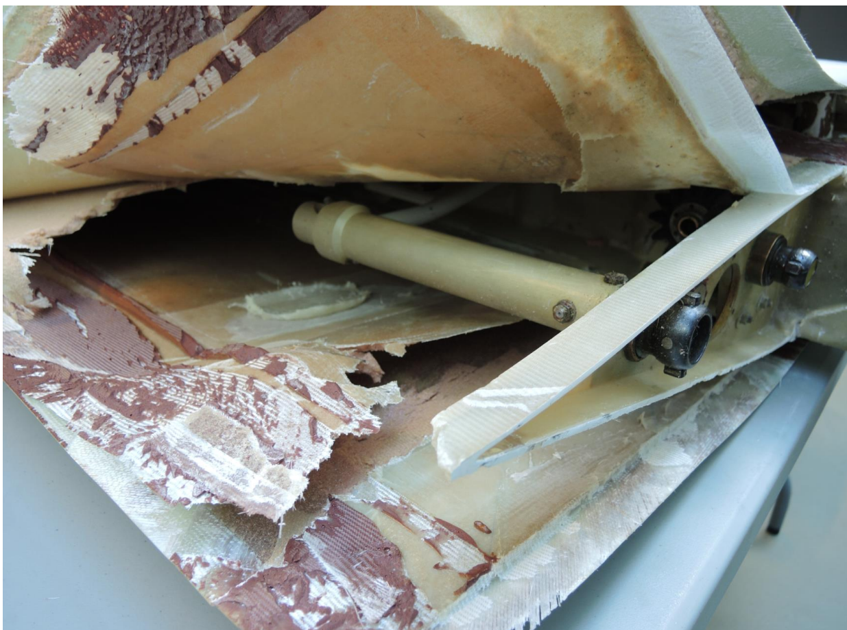
Figur 3: Eksempel på delamineringer i vingeroten. Foto: SHT
