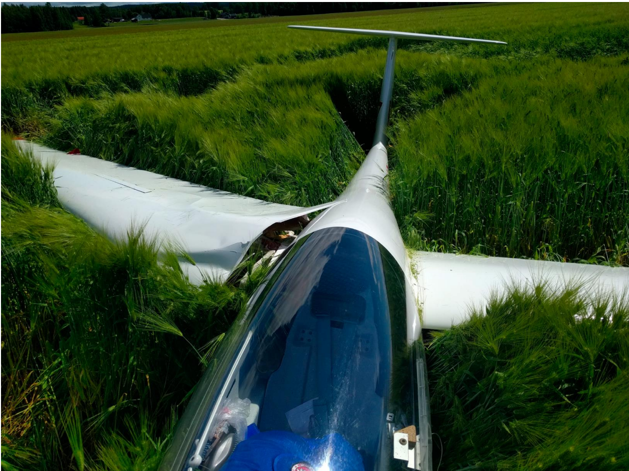
Figur 2: Høyre ving ble brukket bakover i landingen. Foto: NLF
