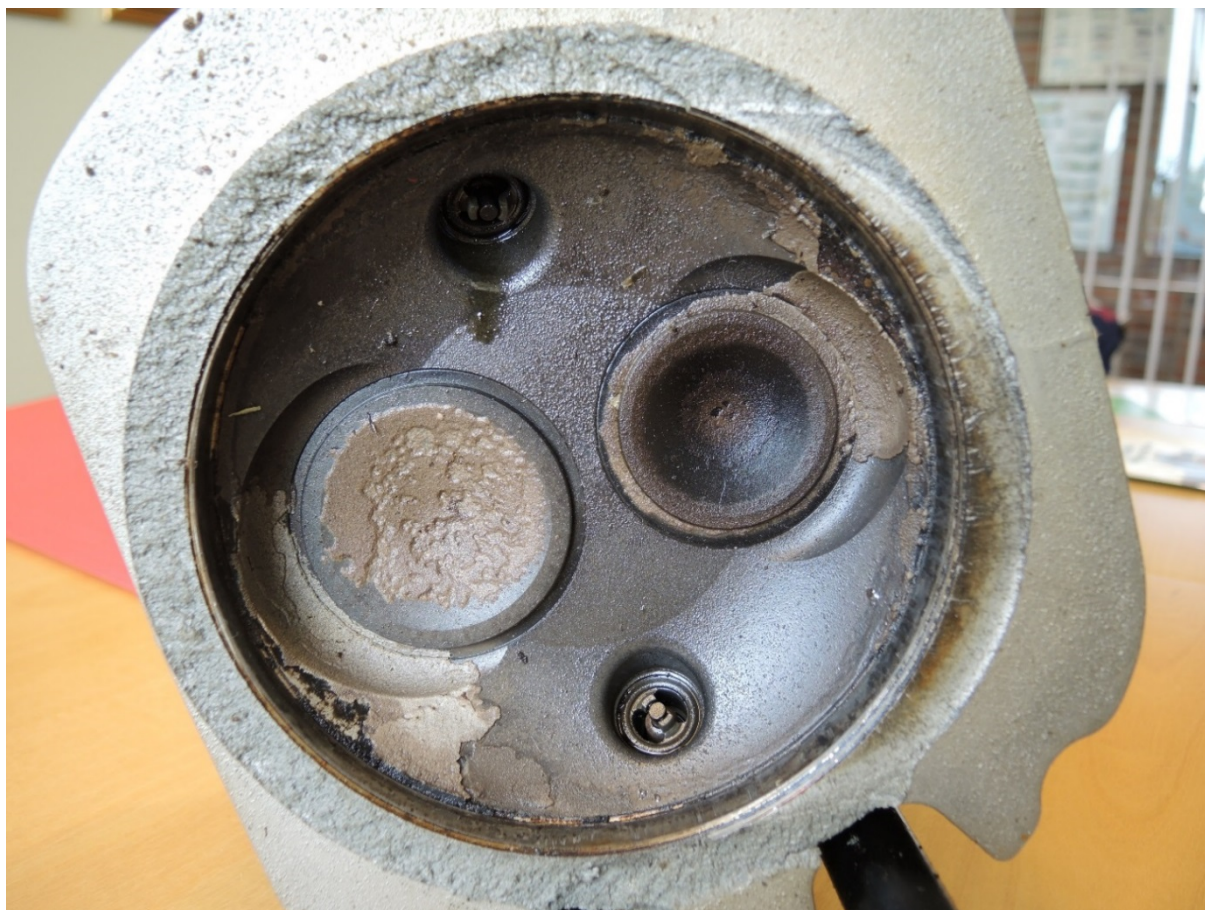
Figur 2: Sprekken etter at sylindertoppen ble tatt av. Sprekken startet til høyre i bildet. Soffarge i høyre del av bruddflaten viser at sprekken har vært åpen i dette området en stund. Foto: SHT
