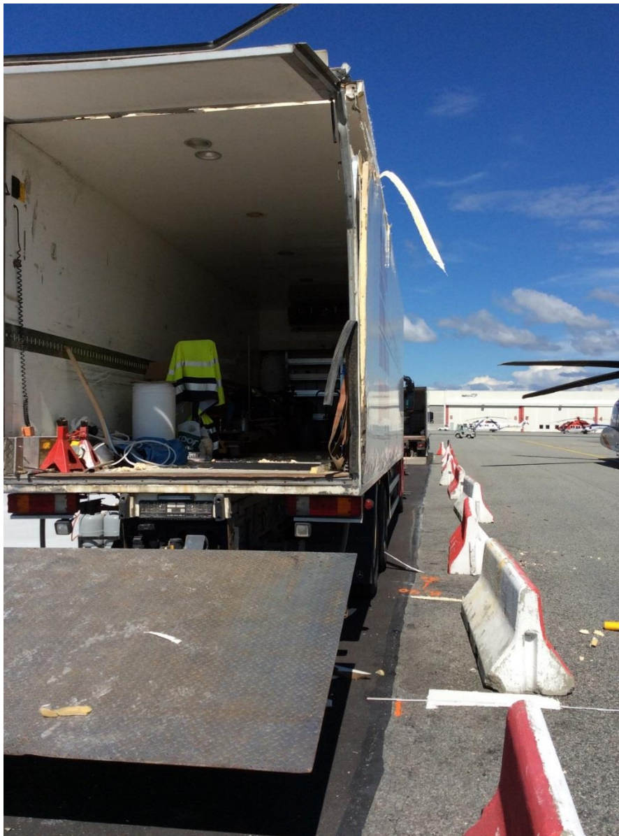
Figur 3: Skapbilen som ble flerret opp av helikopterets hovedrotorblader. LN-OND ses parkert på apron taksebanen til høyre i bildet. De to skapbilene sto parkert etter hverandre på innsiden av en rad med røde og hvite betongblokker. Foto: Styrmann LN-OND
