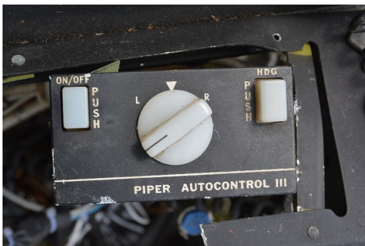
Figur 5: Autopilot-panelet avbildet på havaristedet. Foto: SHT
