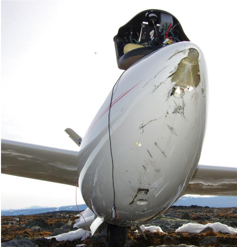
Figur 12: Skader på seilflyets neseparti. Foto: Gudbrandsdal politidistrikt
