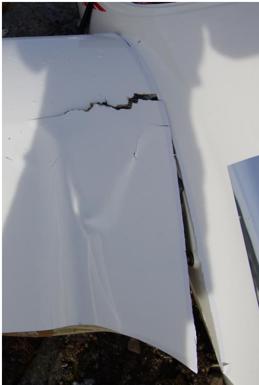
Figur 11: Skader på venstre vingerot. Foto: Gudbrandsdal politidistrikt
