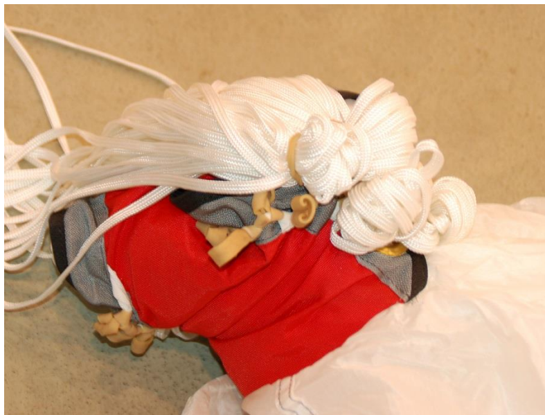
Figur 17: Fallskjermens liner sammenbundet. Foto: SHT
