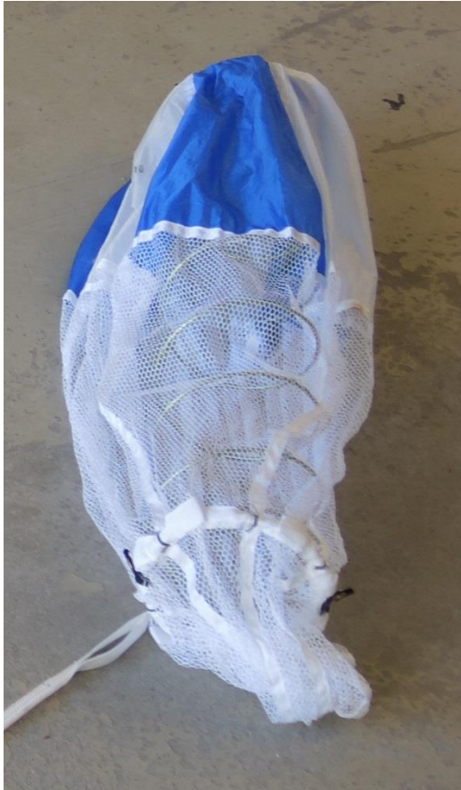
Figur 16: Pilotskjermen ble funnet utløst. Foto: SHT
