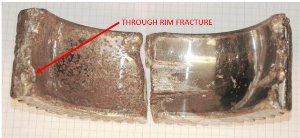
Figur 6: De to delene som ble funnet fra det ødelagte tannhullet. Utmattingsprekken som til slutt delte tannhullet startet i lagerbanen, der den røde pilen peker. Foto: SHT/FOLAT
