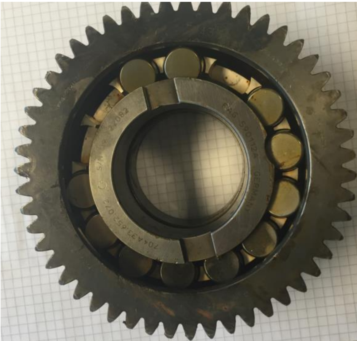
Figur 1: Andretrinns planetgear (funnet med tre manglende ruller). Foto: SHT
