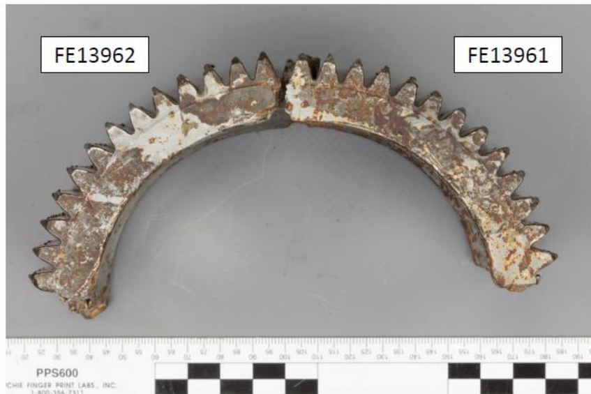
Figur 2: De to delene fra 2. trinns planetgear klargjort for metallurgiske undersøkelser. Foto: QinetiQ
