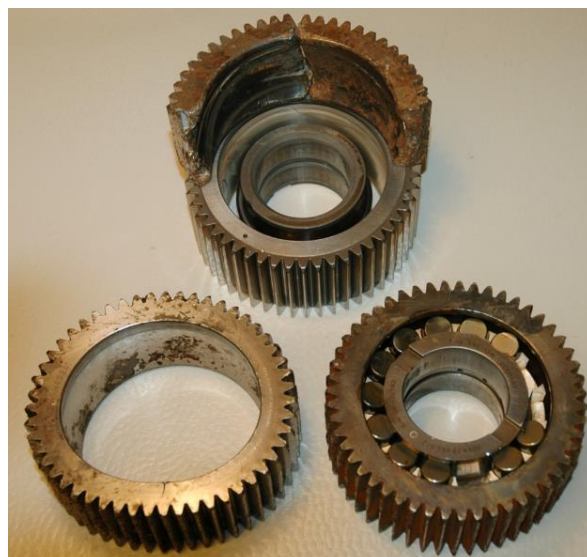
Figur 6: Deler fra andre trinns planetgear. (Det ødelagte tannhullet er lagt oppå et referansetannhjul som ikke var involvert i ulykken). Foto: SHT
