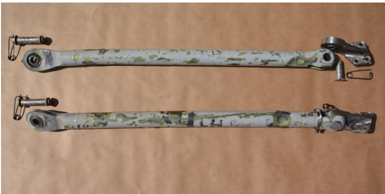
Figur 3: Hovedgearboksens høyre og venstre bakre løftestag med tilhørende festeanordning. Foto: SHT
