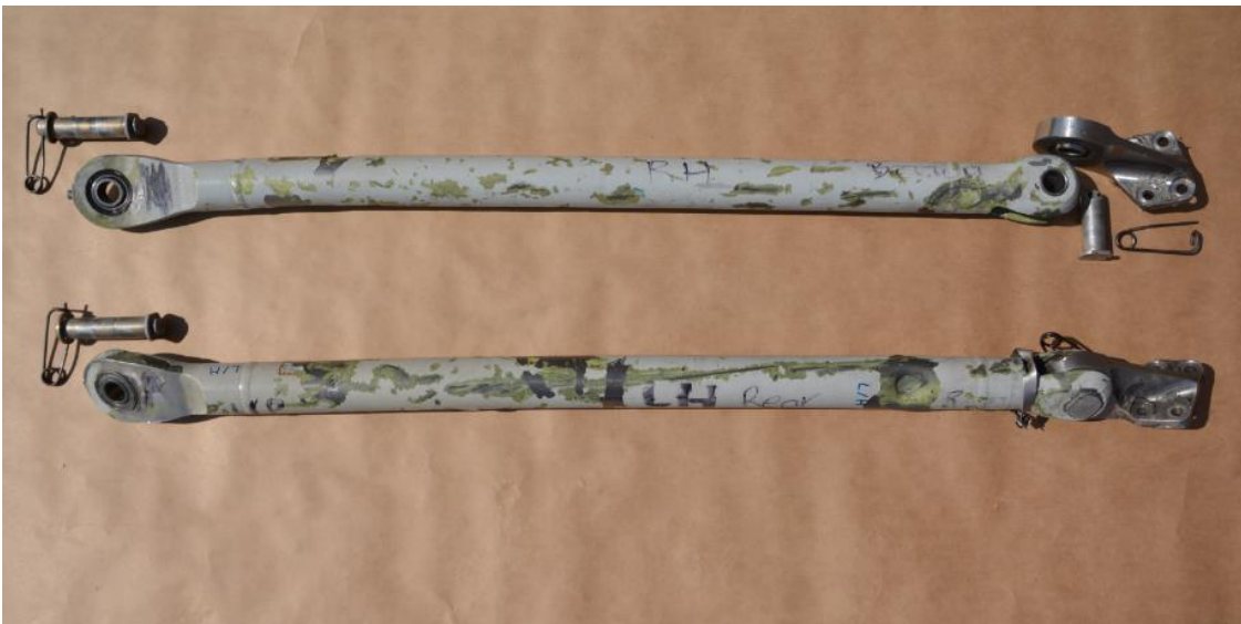
Figur 3: Hovedgearboksens høyre og venstre bakre «suspension bars» med tilhørende festeanordning. Foto: SHT
