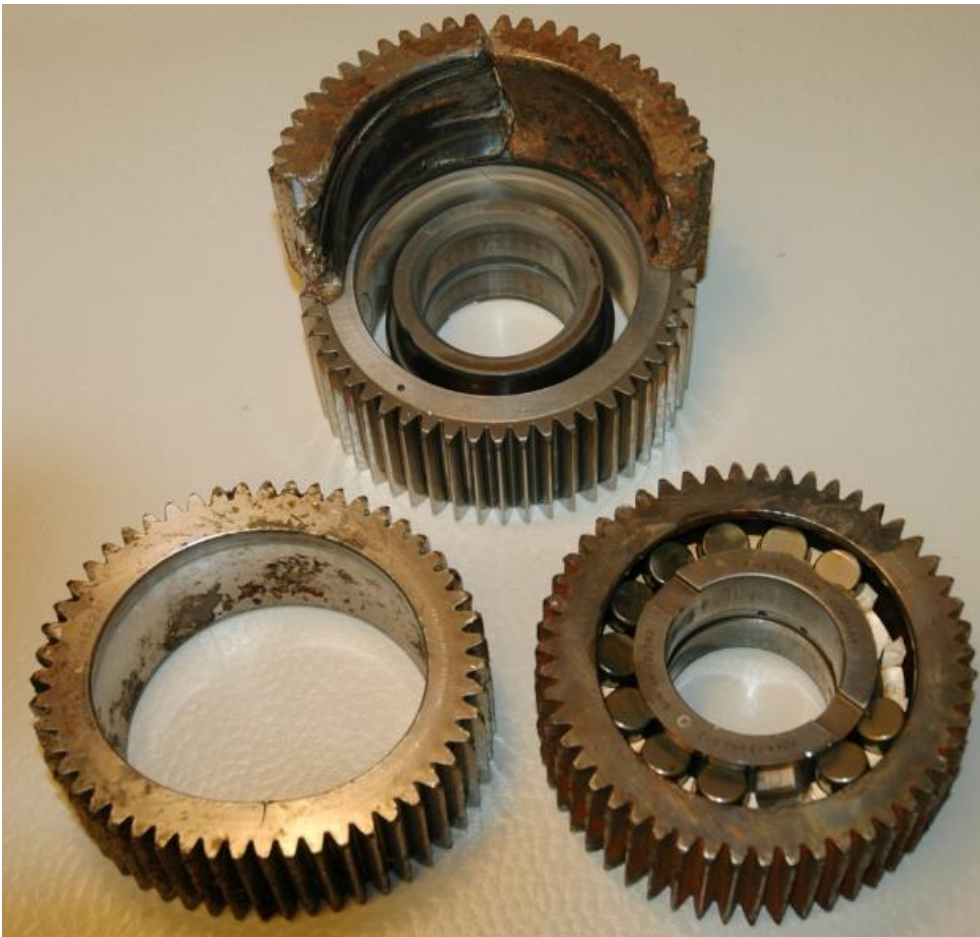
Figur 6: Deler fra andre trinns planetgear. (Det ødelagte tannhjulet er lagt oppå et referansetannhjul som ikke var involvert i ulykken). Foto: SHT
