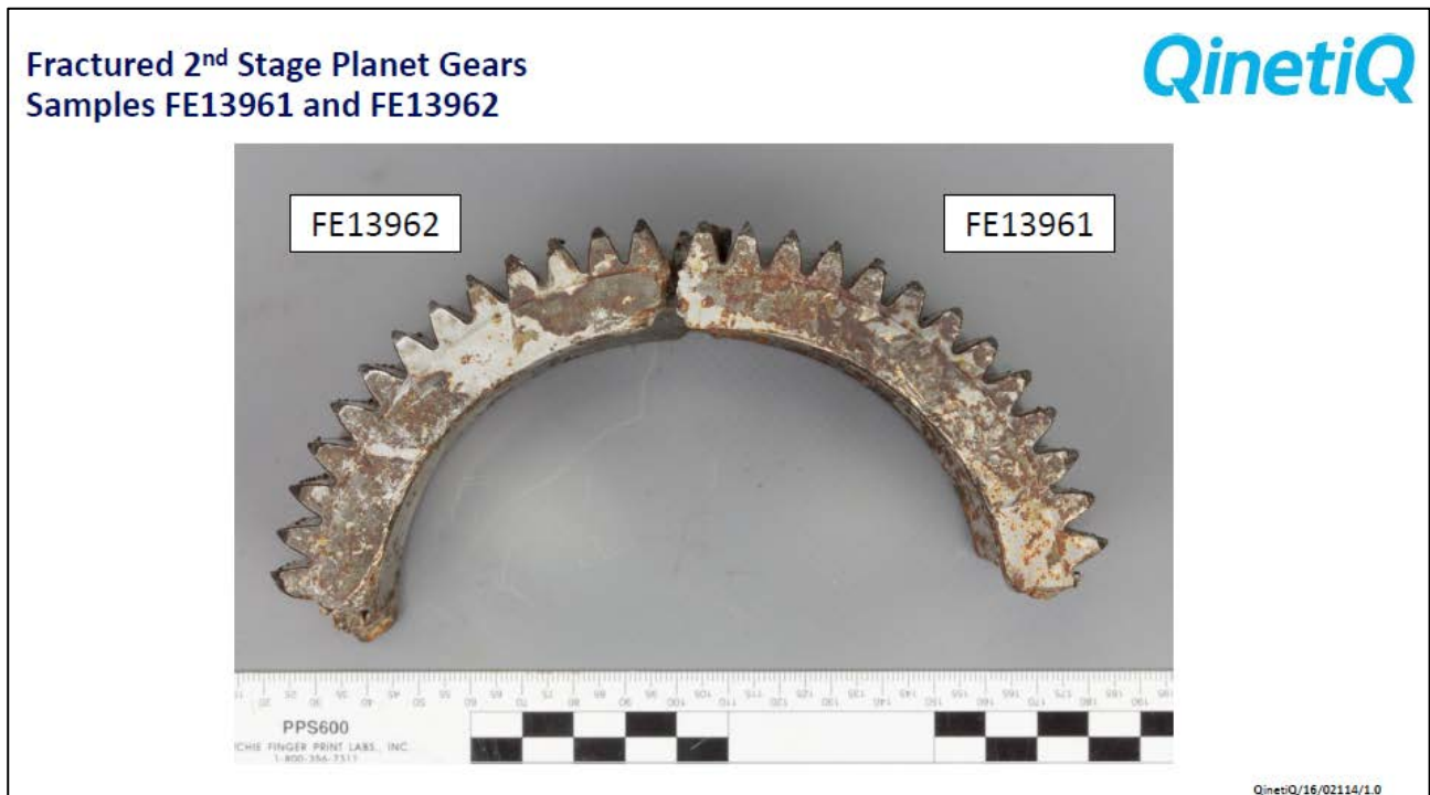
Figur 4: De to delene fra andretrinns planetgear klargjort for metallurgiske undersøkelser. Bruddflaten med utmatting er til høyre i bildet. Foto: QinetiQ
