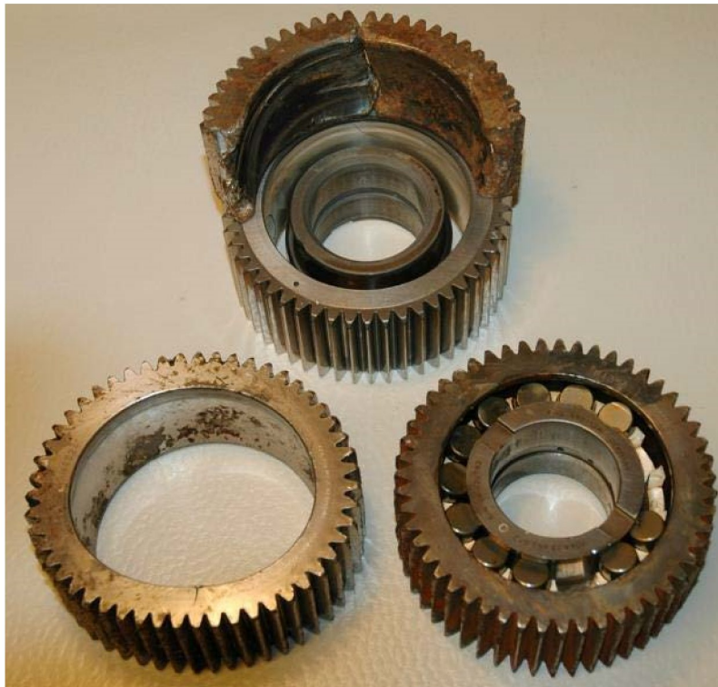
Figur 2: Deler fra andretrinnns planetgear. (Det ødelagte tannhjul er lagt oppå et referansetannhjul som ikke var involvert i ulykken). Foto: SHT
