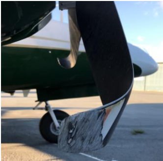
Figur 1: Skader på samtlige seks propellblad. Foto: Politiet
