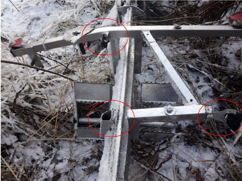
Figur 12: Bildet viser hvordan venstre seksjon av den bærende rammekonstruksjonen for gyrokopteret LN-YUR var brukket på to steder og adskilt fra den øvrige rammen. Setebelteinnfestningen på høyre side var intakt. Foto: Lakselv mikroflyklubb
