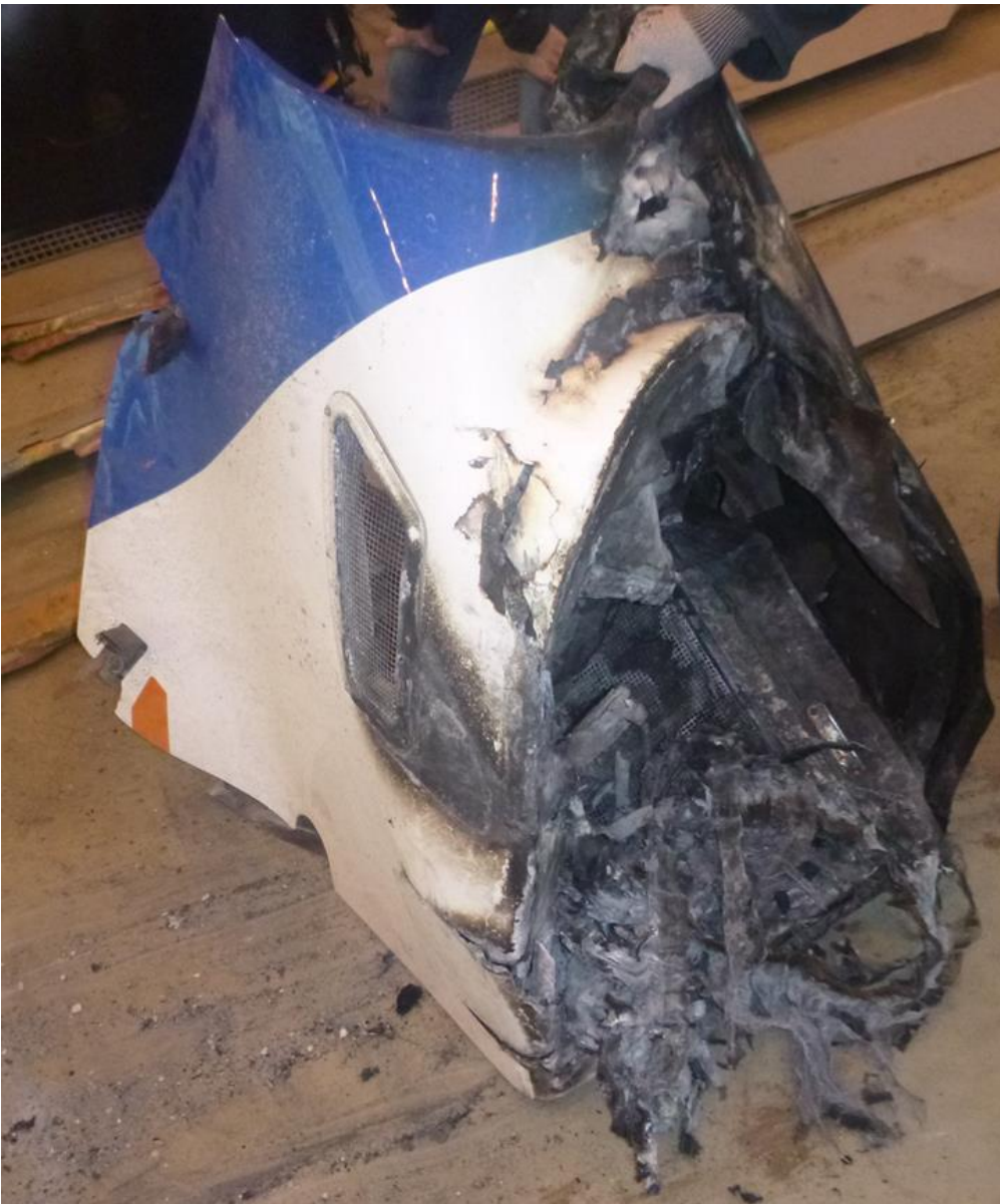
Figur 7: Motordeksel med oppbrent luftinntaksfilter. Foto: SHT
