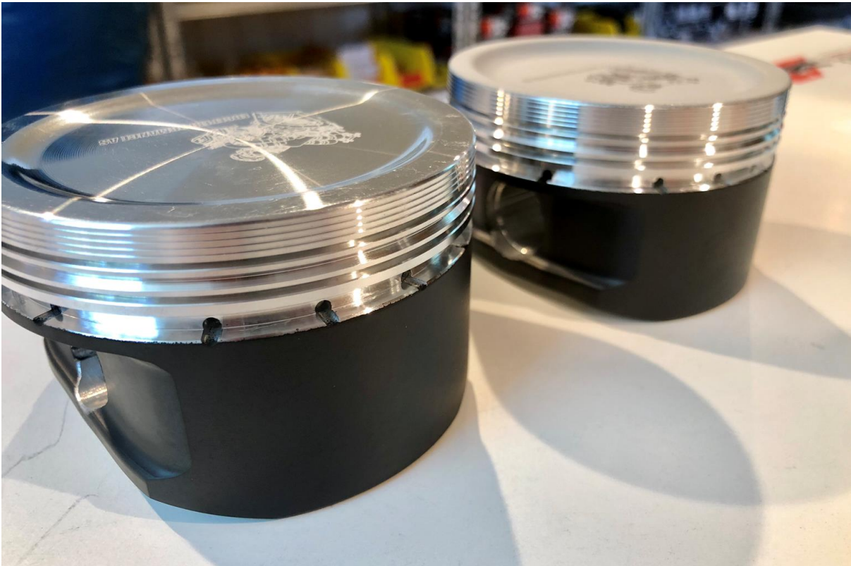
Figur 19: Nytt design på «Big Bore» stempler. Foto: EdgePerformance
