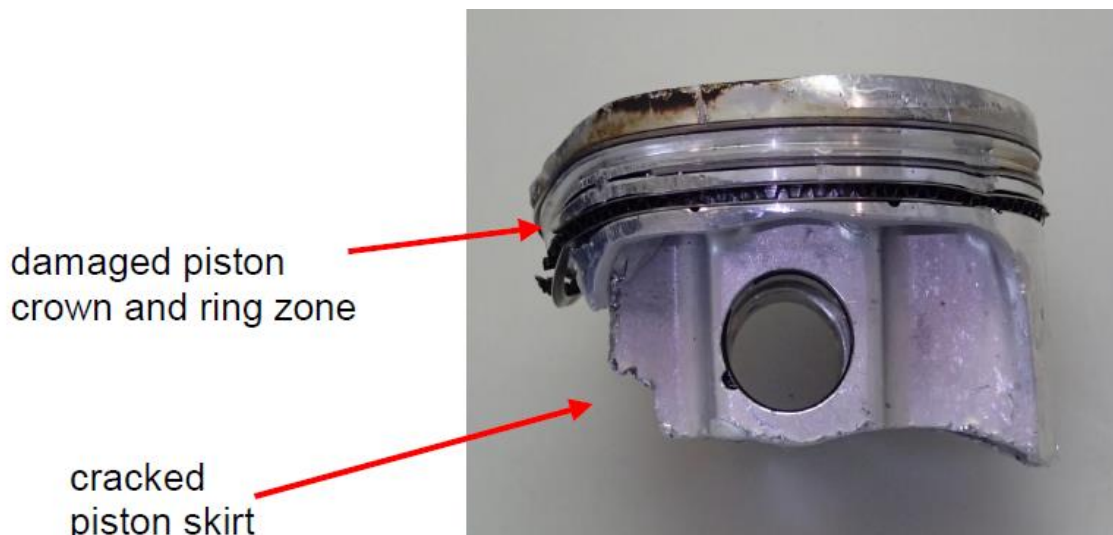
Figur 6: Skader på stempel nr. 2. Kilde: Rotax
