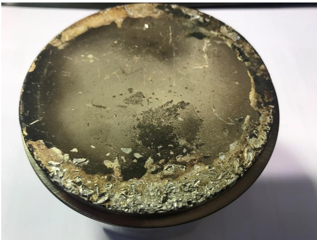
Figur 9: Skader i stempelkrone på stempel nr. 4. Foto: SHT
