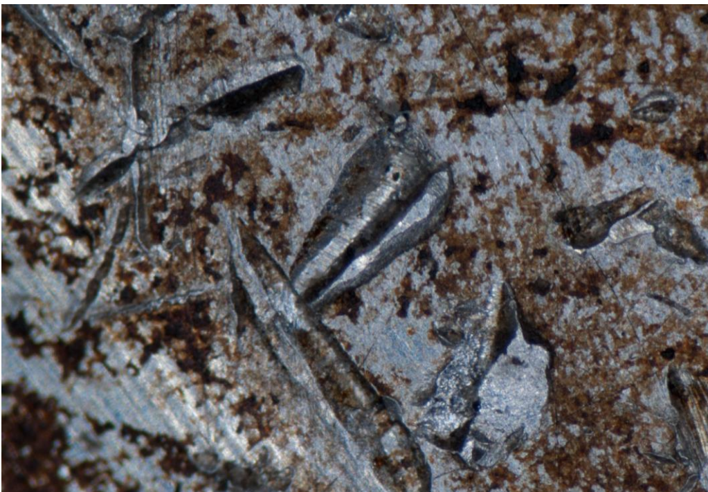
Figur 11: Skader på stempeltopp på sylinder nr. 2. Foto: SHT
