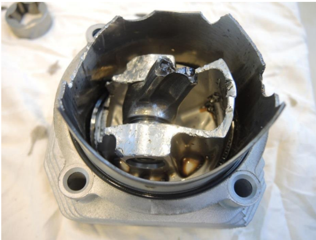
Figur 8: Sylindere nr. 2 med stempel og øvre del av råde. Foto: SHT
