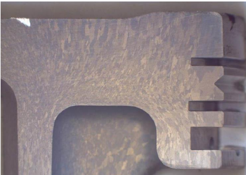
Figur 17: Grov granulær struktur i stempler. Foto: Rotax
