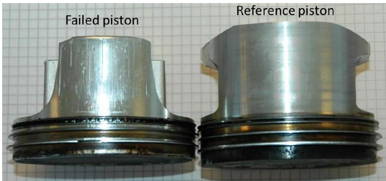
Figur 4: Sammenligning. Originalt stempel fra Rotax til høyre. Foto: SHT/FOLAT
