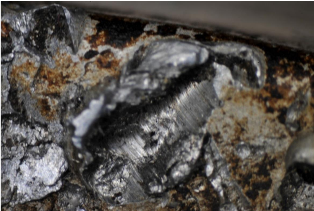
Figur 10: Spor etter fremmedlegemer på stempeltopp på sylinder nr. 4. Foto: SHT/FOLAT
