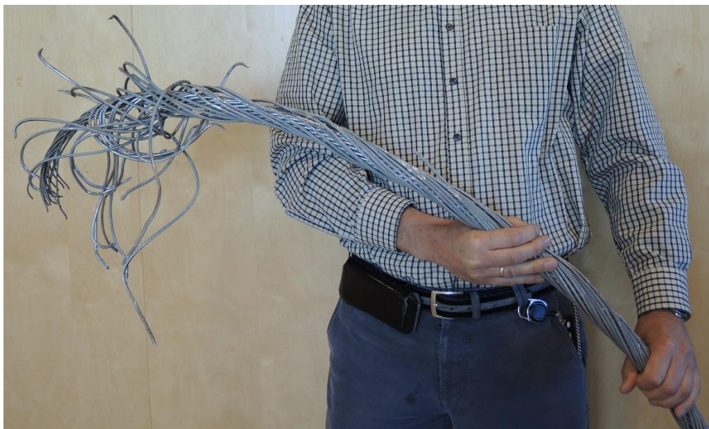
Figur 2: Enden av en av de strømførende lederne som ble kuttet. Foto: SHT
