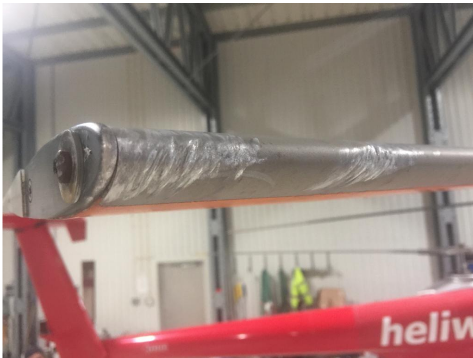
Figur 1: Skadene på tippen av det ene rotorbladet. Foto: Heliwest
