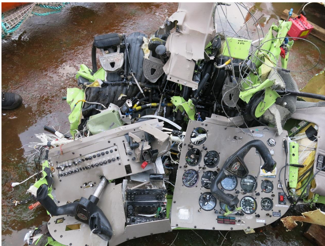
Figur 6: Instrumentpanelet og flygekontrollene etter at det ble løftet opp på dekket til bergingslekteren. Foto: SHT
