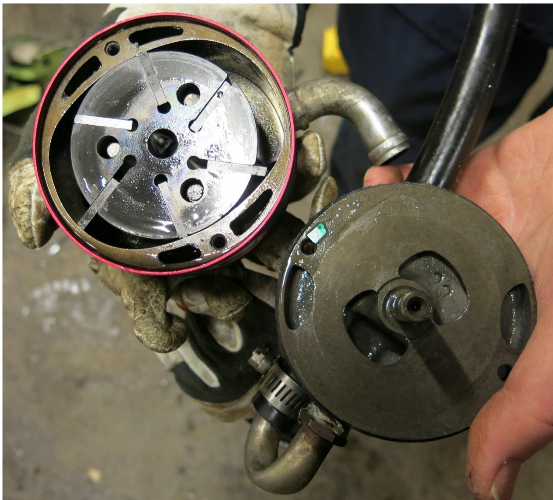
Figur 7: Vakuumpumpen etter at den ble åpnet opp. Foto: SHT
