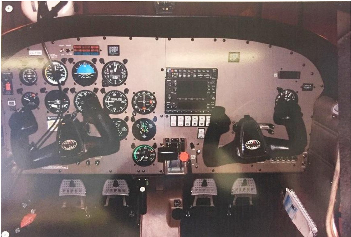
Figur 1: Instrumentpanelet på LN-TOS. Seks av de åtte hvite bryterne på rekke er synlig midt på bildet. Foto: Tromsø flyklubb
