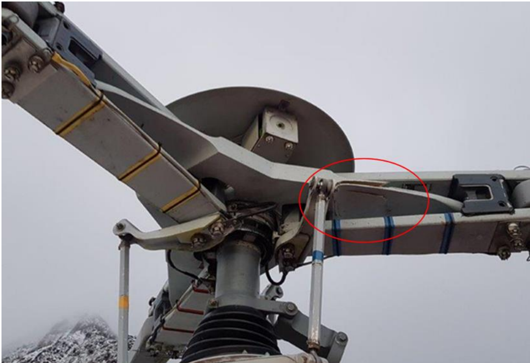
Figur 6: Et typisk brudd i «starflex» armen etter at en lastebag blåste opp i rotoren på en AS 350 B3 i 2017 (ref: SHT rapport SL 2018/05). Foto: Helitrans AS
