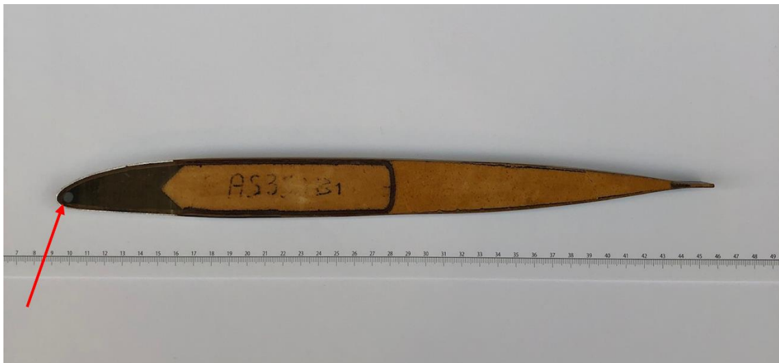
Figur 11: Snitt/profil av AS 350 hovedrotorblad. Pilen markerer ca. treffpunkt på rødt blad. Foto: SHT
