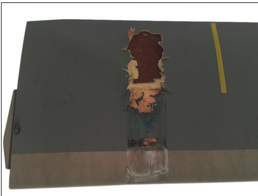
Figur 9: Skade på blått blad. Foto: Heli-Team AS
