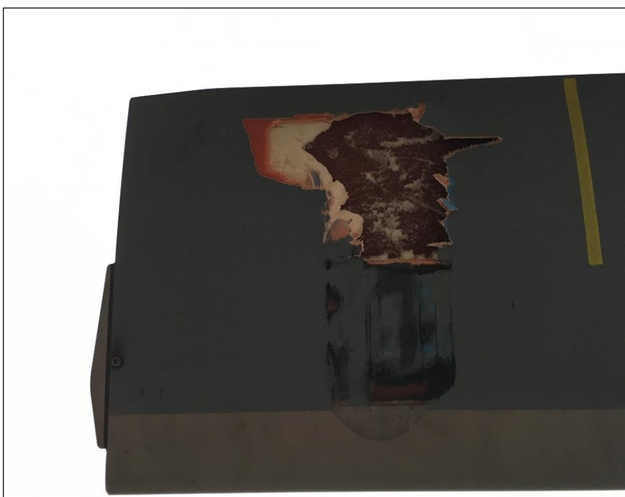
Figur 10: Skade på gult blad Foto: Heli-Team AS
