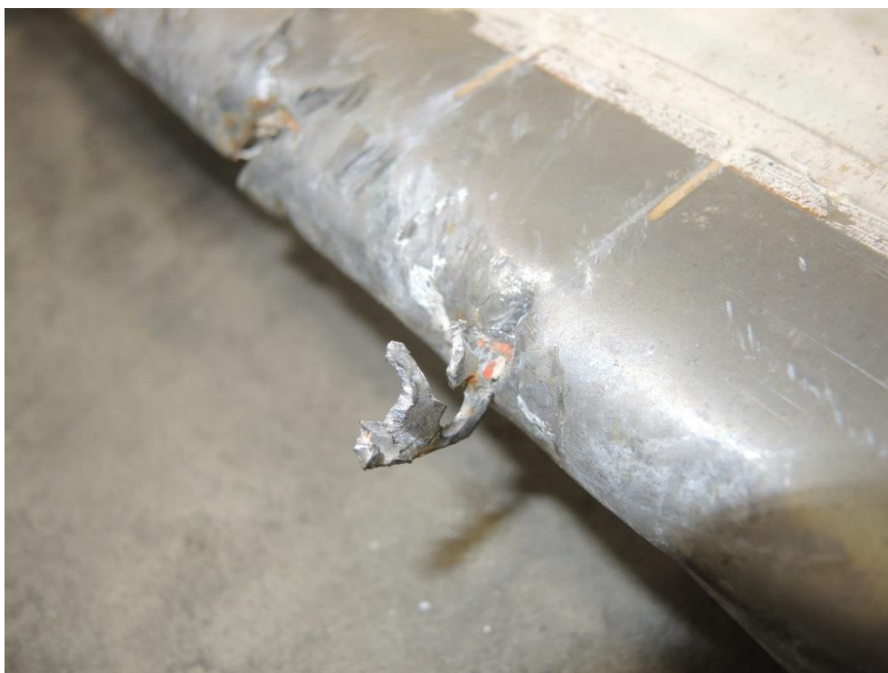
Figur 6: Fragment av ferdsskriveren innslått i forkant av et hovedrotorblad. Foto: SHT
