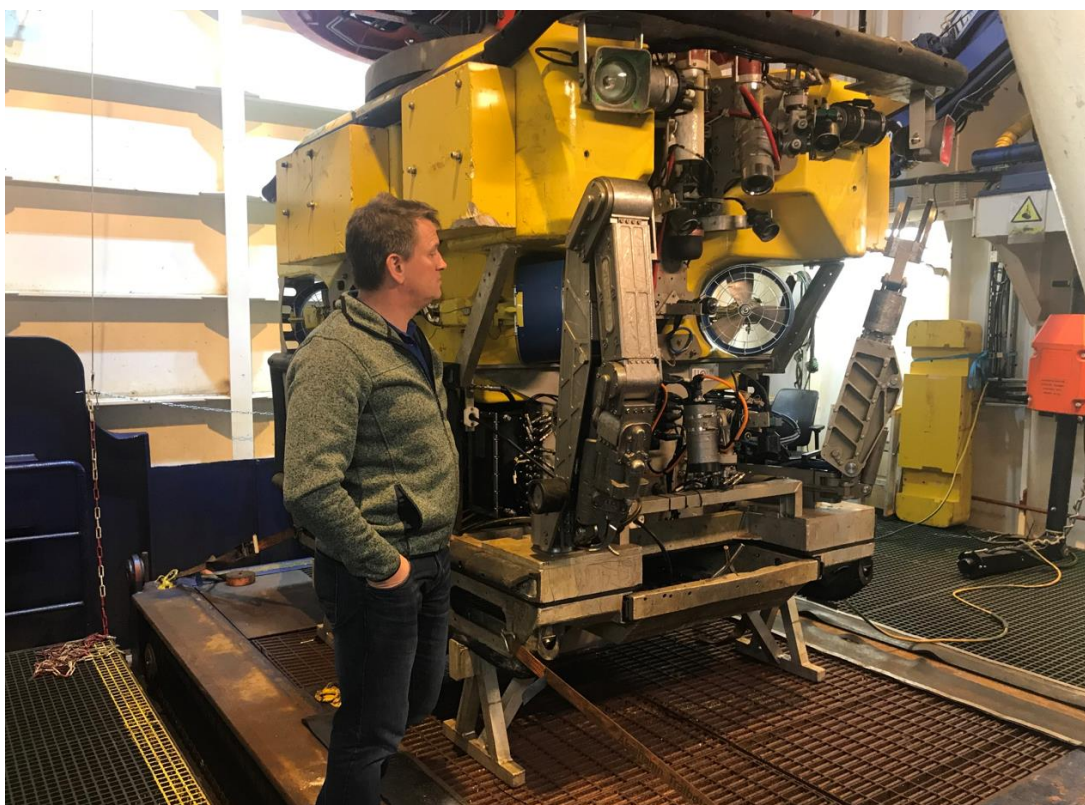
Figur 13: Maersk Forza ROV with manipulator arms. Foto: SHT
