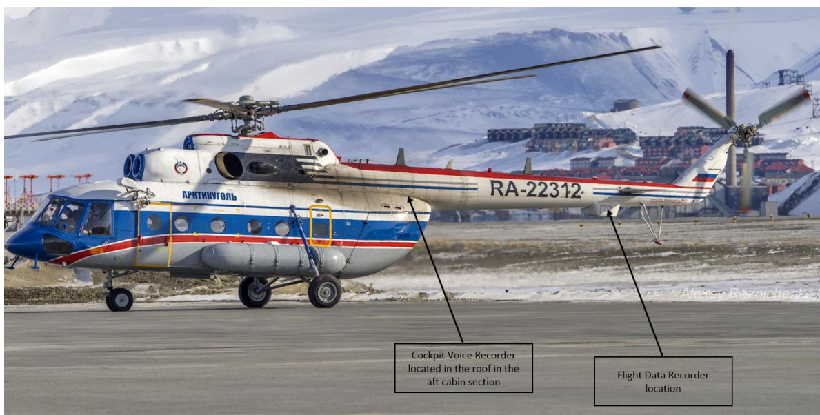
Figur 5: Plassering av CVR og FDR. Foto: Alexey Reznichenko. Illustrasjon: SHT
