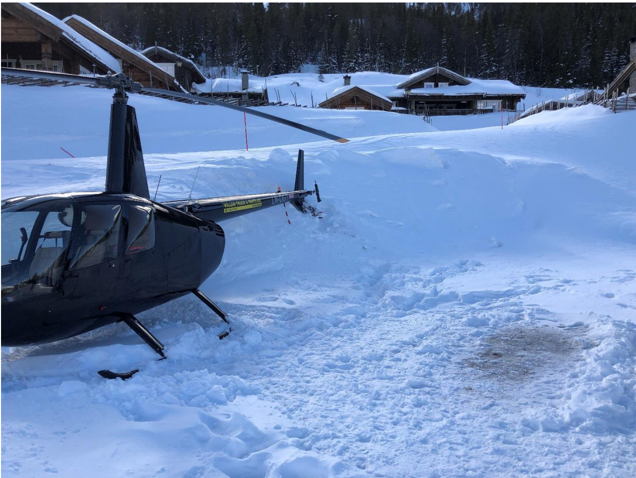
Figur 2: Helikopteret på avgangsplassen etter hendelsen. Målinger viste at helikopteret hadde driftet ca. 4 meter mot høyre i retning den snødekte skråningen før sammenstøtet. Foto: SHT
