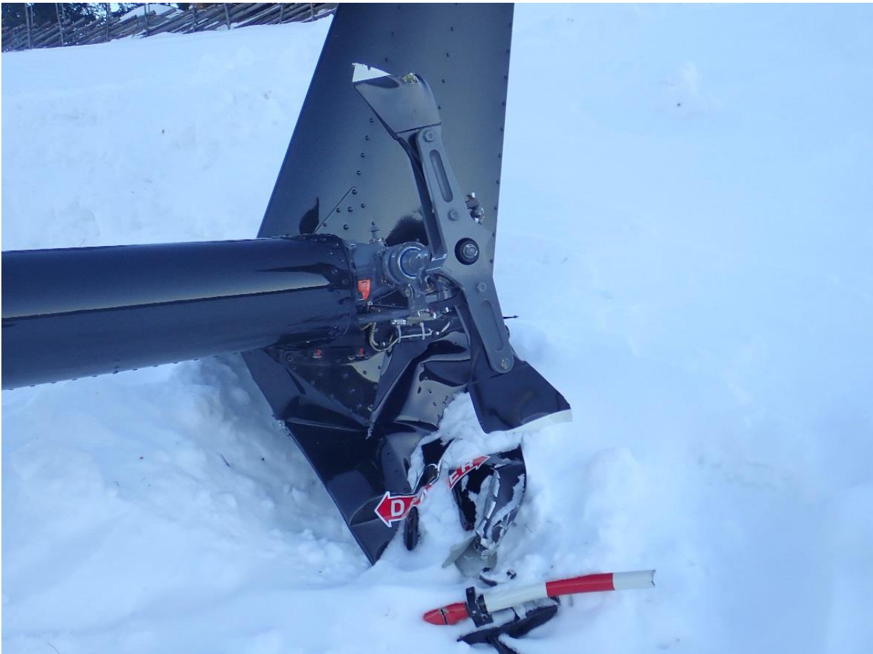
Figur 4: Det ble store skader på halerotor og vertikalfinne. Foto: SHT
