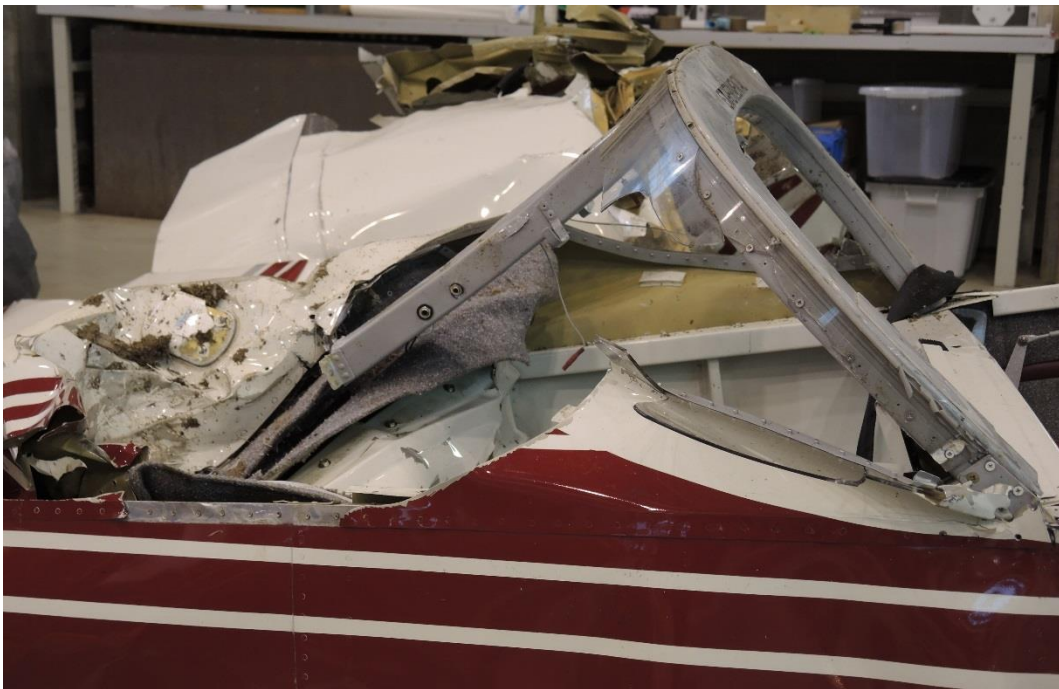
Figur 14: Bøylene bak i cockpit som ble bøyd helt bakover og ned (mot venstre i bildet). Etter at flyet ble snudd, rettet bøylene seg delvis opp igjen. Foto: SHT
