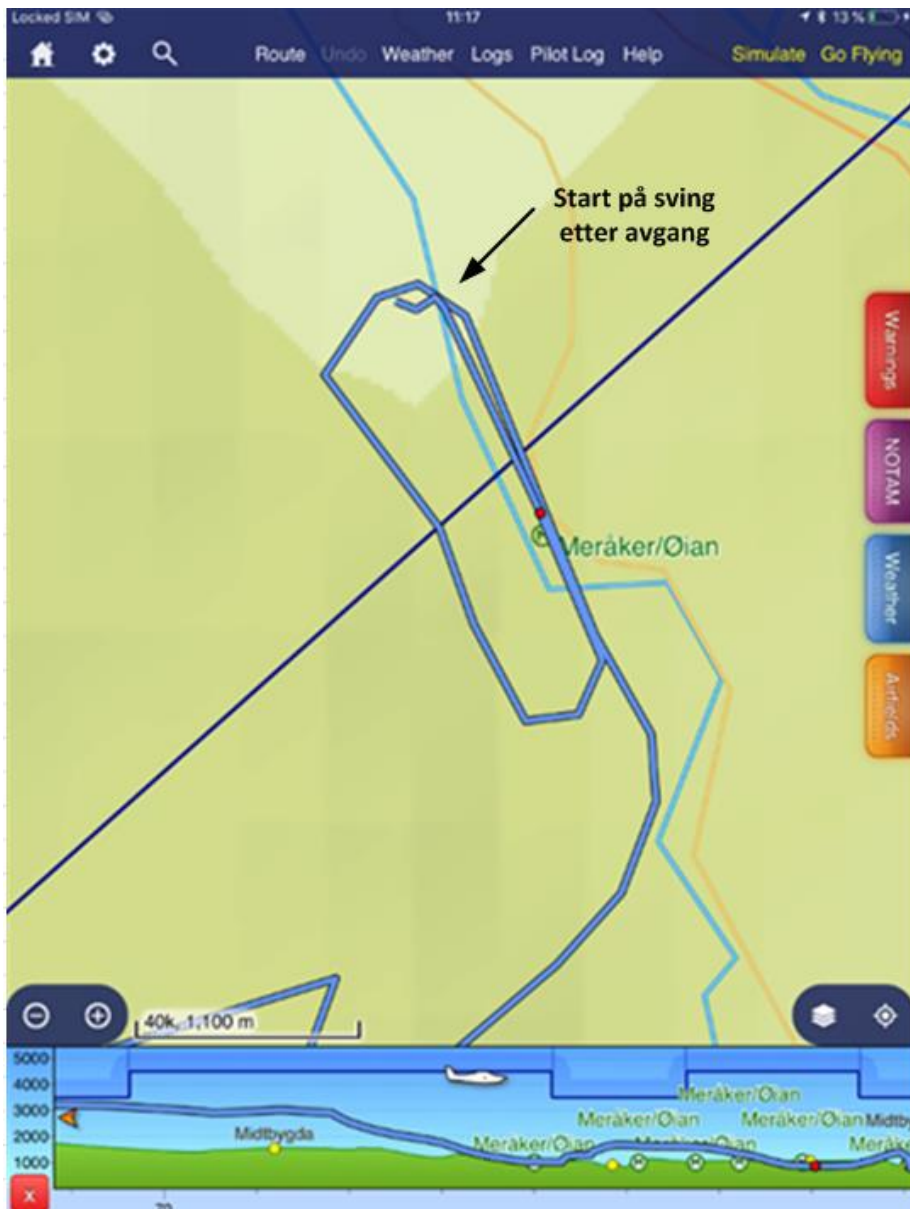
Figur 2: Kart fra SkyDemon som viser landingsrunden og siste avgang fra Øian flyplass. Den røde prikken indikerer at systemet mistet GPS dekning en kort periode mens flyet var på bakken. Kilde: SkyDemon
