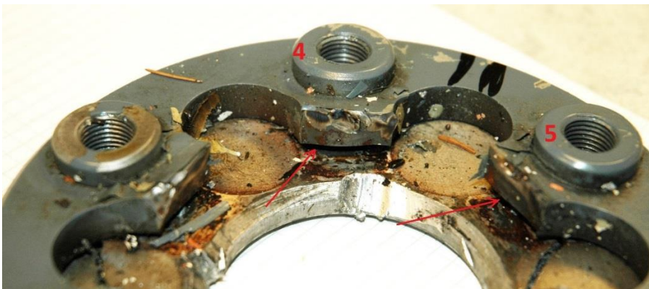
Figur 18: Deler av propellflensen med deler av skiven som driver generatorremmen og holder starterkransen under. Pilene viser åpningen som har oppstått etter at bruddflatene ved propellerbolt nr. 4 og 5 har blitt bøyd opp. Foto: SHT
