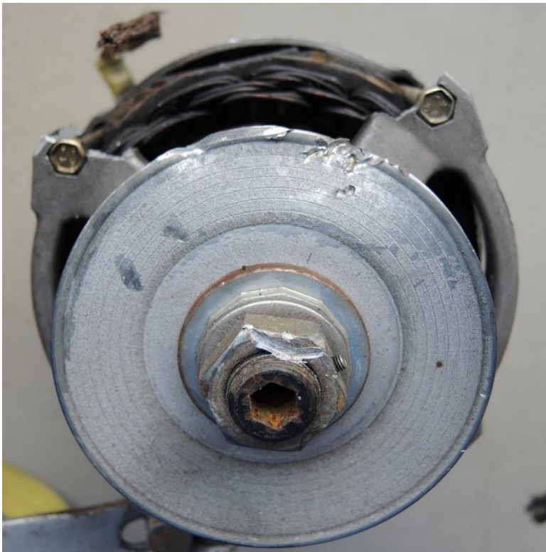
Figur 17: Remskiven på generatoren var slått skjev. Øverst på bilde sees også at generatorhuset er slått istykker. Foto: SHT
