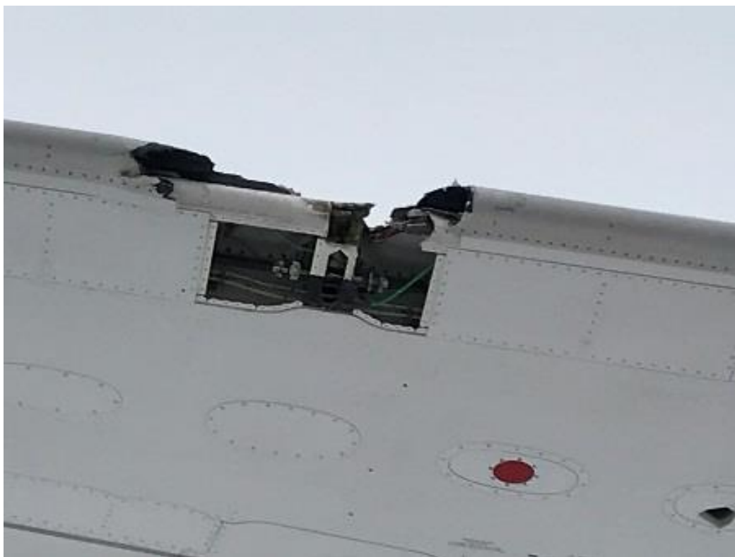
Figur 12: Skaden med «surge tank» i bakgrunnen. Foto: SHT
