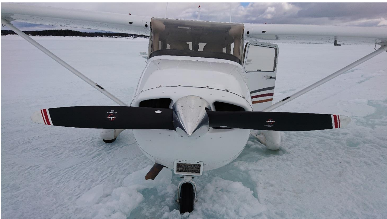
Figur 3: Bildet viser hvordan LN-KAB har trengt ned i den lagdelte isen. Høyre hovedhjul står på det øvre islaget (sørpeislaget), mens nesehjulet og venstre hovedhjul har trengt ned i vann/sørpelaget under. Foto: Fartøysjef LN-KAB
