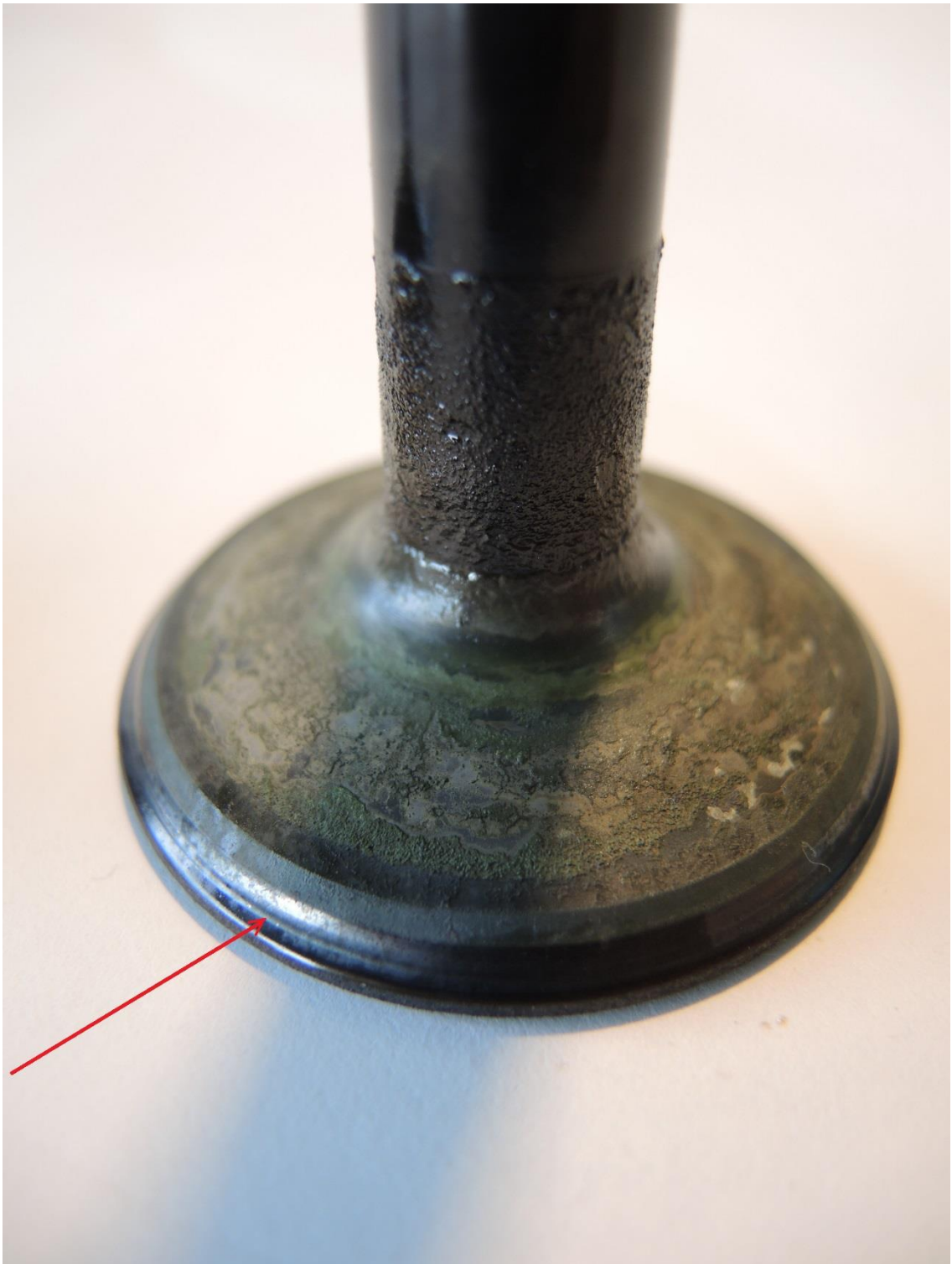
Figur 9: Eksosventilen fra sylinder nr. 5. Pilen peker på skadene langs anleggsflaten. Fargen på ventilen er lys brun med innslag av grønt. Foto: SHK
