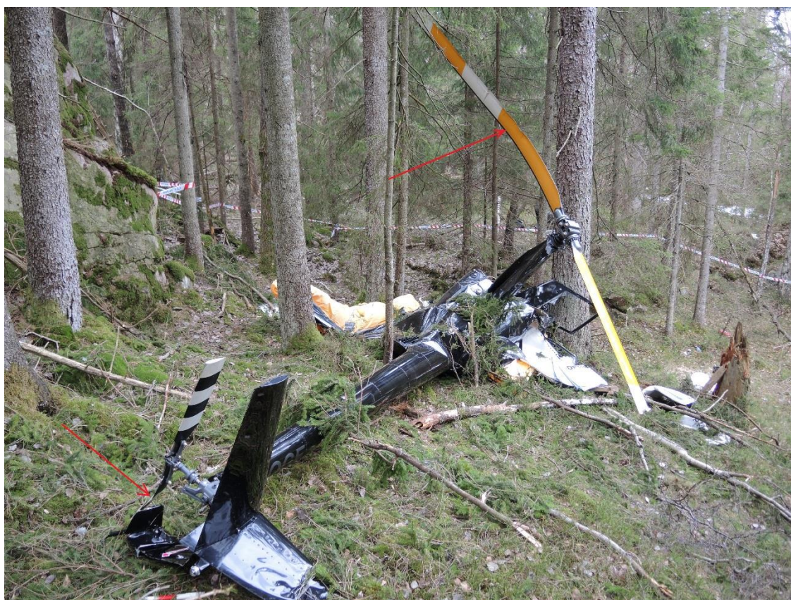
Figur 3: Havaristedet sett mot nordvest. Røde piler viser knekk på det ene halerotorbladet og buen på det ene hovedrotorbladet. Foto: SHK
