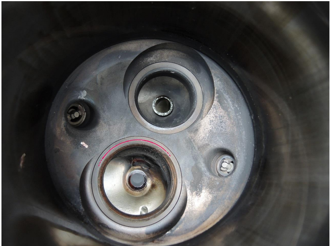
Figur 8: Sylinder nr. 5 innvendig etter at ventilene er tatt ut. Den uskadede sektoren av setet til innsugsventilen er markert med rød strek. Den skadede sektoren er mørkere/brun. Forøvrig kan det bemerkes at sylinderen er ren og lys i fargen. Foto: SHK
