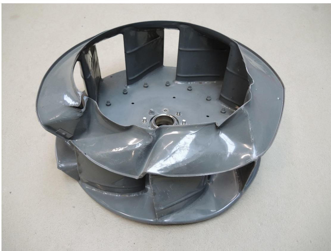
Figur 5: Motorens kjølevifte var slått flat på undersiden. Det var ingen synlige spor som tyder på at den hadde rotert mens den ble skadet. Foto: SHK
