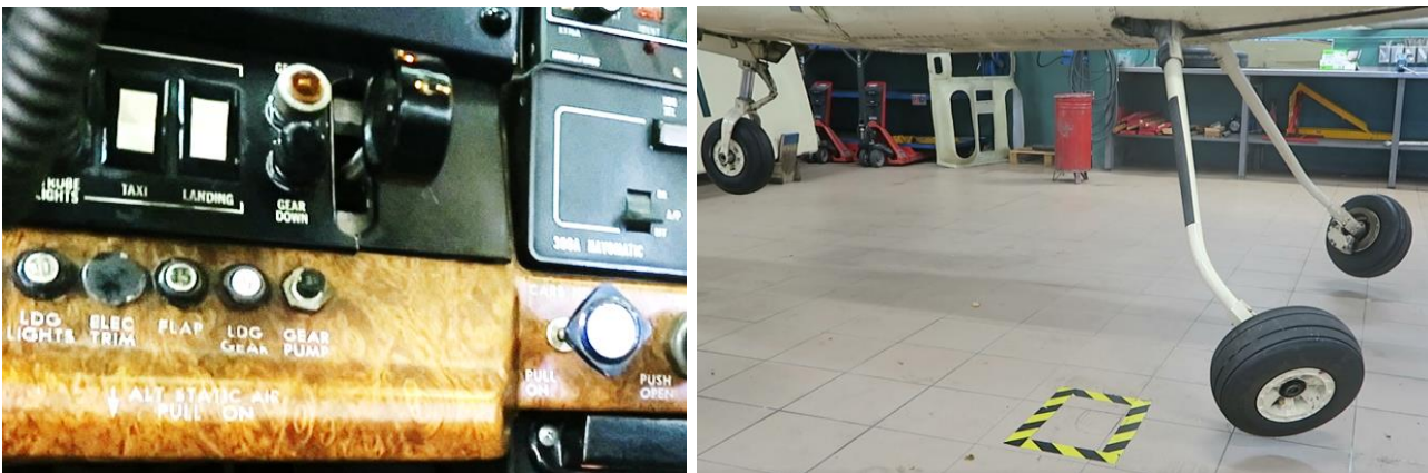
Figur 2: Hjulhåndtak delvis nede. Flyets hovedhjul delvis utfelt mens nesehjul er helt nede. Foto: SHK
