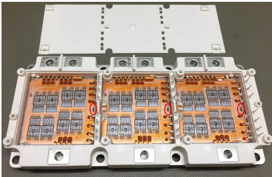
Figur 9: De tre elektronikk-kamrene i strømstyringsenheten. Tre IGBT-transistorer med tilhørende temperatursensorer er markert med rød ring. Illustrasjon: EMSISO
