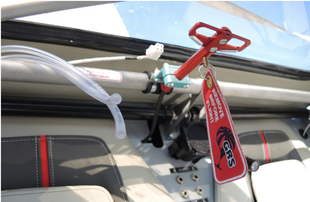
Figur 11: Håndtaket for utløsning av redningsfallskjermen. Foto: Statens havarikommisjon
