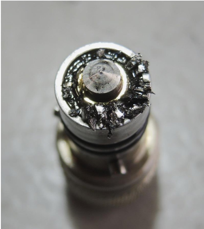
Figur 8: Magnetpluggen fra hovedgirboksens akselinngang. Foto: SHK
