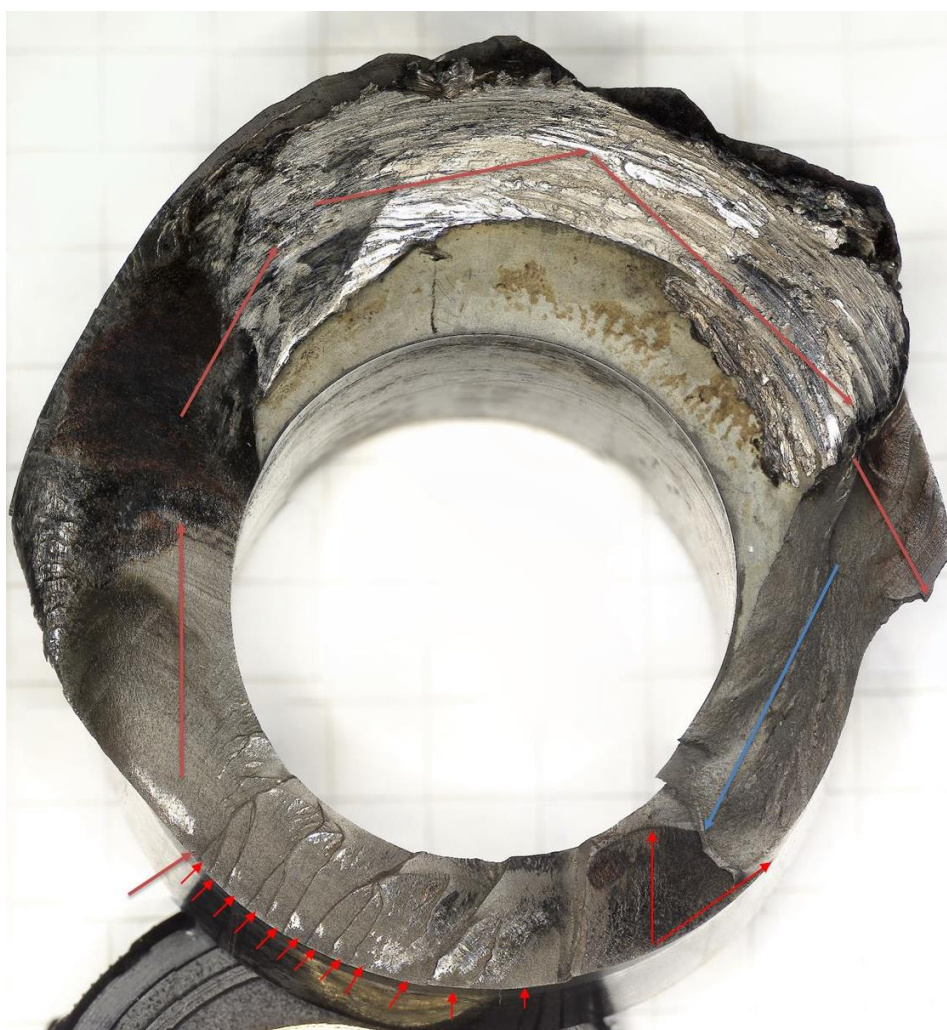
Figur 15: Bilde fra digitalmikroskop av bruddflaten med minst sekundærskade i området hvor sprekken startet (akseldelen). De korte røde pilene peker mot en rekke initieringspunkter for utmattingssprekken. Den blå pilen illustrerer lengden på restbruddet. Foto: SHK/FOLAT
