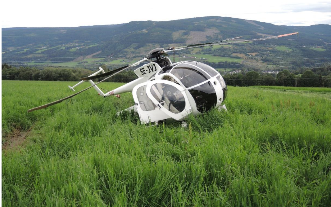
Figur 3: Bilde av SE-JVJ tatt mot sørvest. Til venstre i bildet ses spor etter hovedrotorbladene som slo i bakken. Foto: SHK
