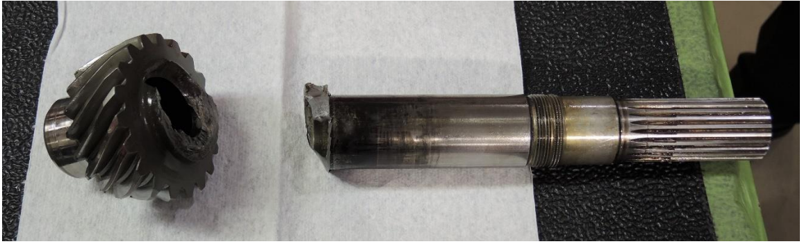
Figur 9: Den inngående akseltappen delt i to med tannhjuldelen til venstre og akseldelen til høyre. Foto: SHK
