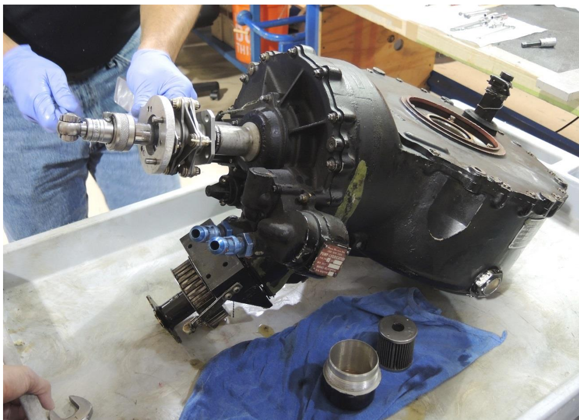
Figur 4: Hovedgirboksen før demontering hos MD Helicopters i Arizona. Foto: SHK
