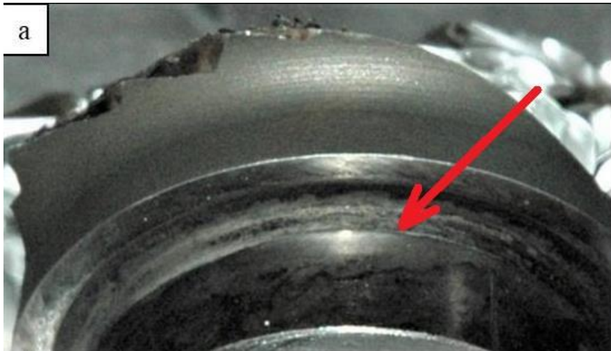
Figur 16: Pilen peker på radiusen i overgangen mellom aksel og tannhjul. Foto: SHK/FOLAT
