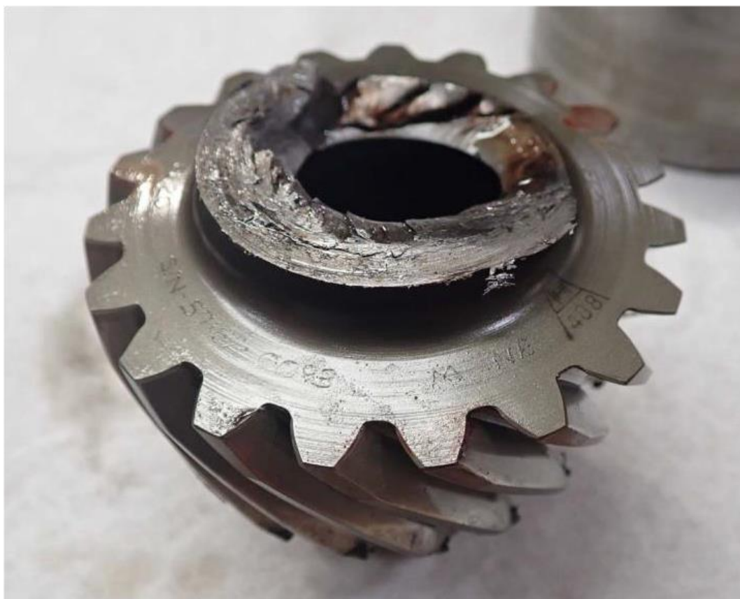
Figur 13: Bruddflaten på den delen av akseltappen hvor tannhjulet sitter. Foto: SHK/SEMTEC Laboratories
