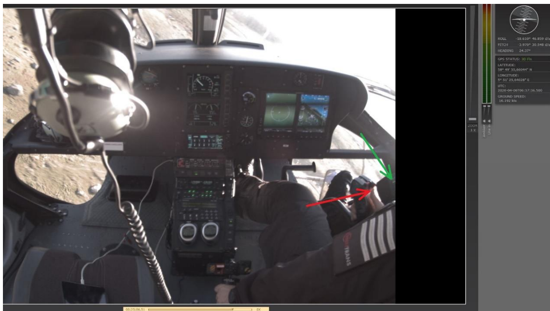
Figur 3: I ytre høyre billedkant vises to grønne lys (grønn pil) som indikerer at belastningen i lastekroken har passert 100 kg. Fartøysjefen trykker på knappen på cyclic-stikka for å frigjøre lasten (rød pil). Etter at helikopteret kom ut av kontroll har det på dette tidspunktet dreiet 116° til venstre. Nesestillingen har sunket til -4^{\circ} . Kilde: Appareo Vision 1000/SHK
