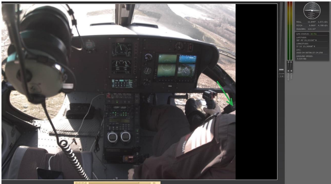
Figur 2: Helikopteret har krenget (rollet) 11,6^\circ til venstre og har nesene 6^\circ opp. Fartøysjefen har cyclic-stikka helt over til høyre og den høyre foten har nettopp sklidd av pedalen. I ytre høyre billedkant vises kun ett grønt lys som indikerer at det er mindre enn 100 kg strekk i lastekroken (grønn pil). Kilde: Appareo Vision 1000/SHK
