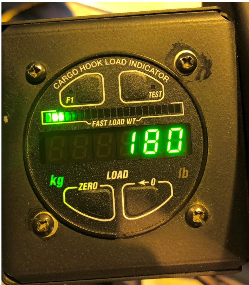
Figur 5: To grønne dioder lyser ved en belastning på 180 kg. Reflekser i glasset kan gi inntrykk av at hele fire dioder er tent. Foto: Helitrans AS
