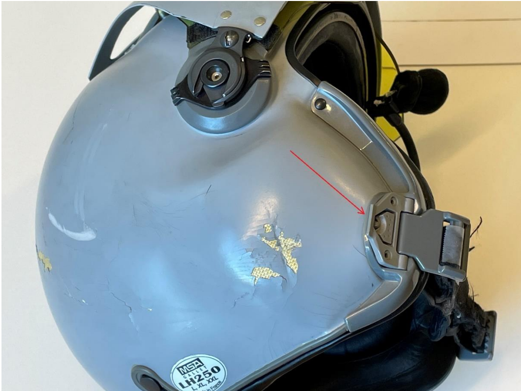
Figur 13: Fartøysjefens hjelm med skader på høyre side. Pilen peker mot låsen til hakestroppen som gikk opp. Foto: SHK
