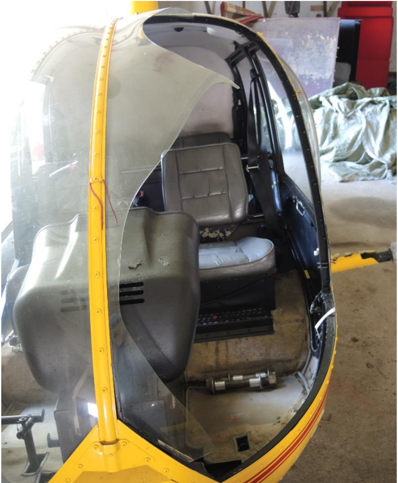
Figur 4: Helikopteret sett forfra. Venstre frontrute, foran passasjeret er knust. Foto: Statens havarikommisjon
