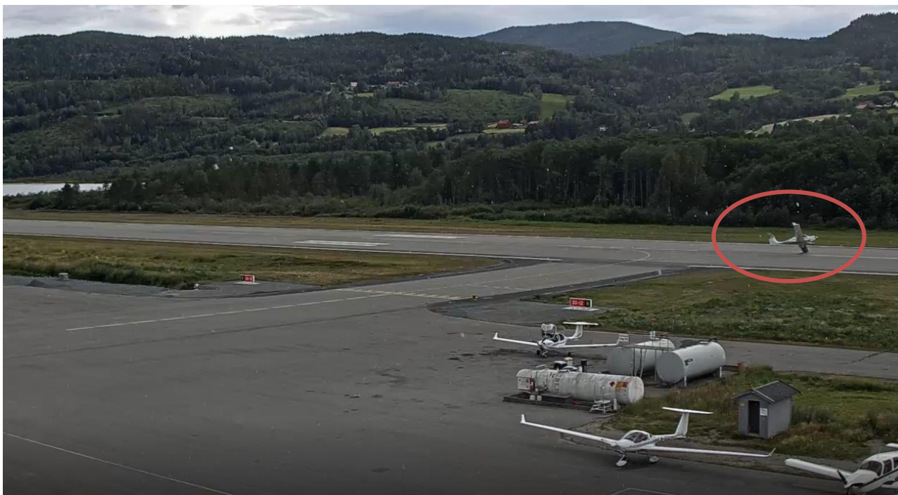
Figur 1: Stillbilete av LN-PFJ, markert med ein raud ring, som har flikka den venstre vengen i asfalten. Video: Notodden lufthamn
