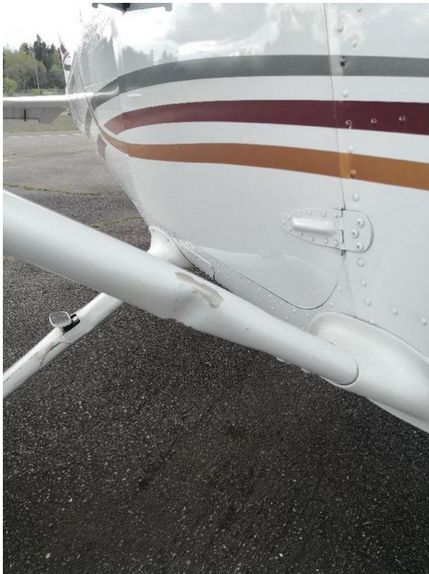
Figur 6: Bulk på vingestag, vinge og deksel til understell (høyre side). Foto: Gjøvik og Toten Flyklubb / SHK
