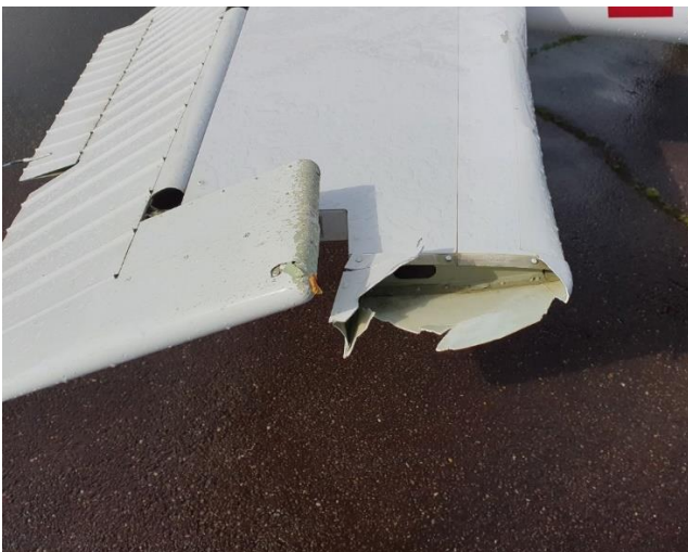
Figur 7: Skadet fremkant og deksel på den høyre horisontale haleflaten som kom i kontakt med høyre høyderor da roret passerte nøytral stilling. Høyderoret ble påført en mindre skade ytterst på høyderoret. Foto: SHK
