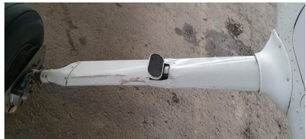
Figur 6: Bulk på vingestag, vinge og deksel til understell (høyre side). Foto: Gjøvik og Toten Flyklubb / SHK
