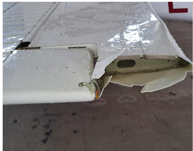
Figur 7: Skadet fremkant og deksel på den høyre horisontale haleflaten som kom i kontakt med høyre høyderor da roret passerte nøytral stilling. Høyderoret ble påført en mindre skade ytterst på høyderoret. Foto: SHK
