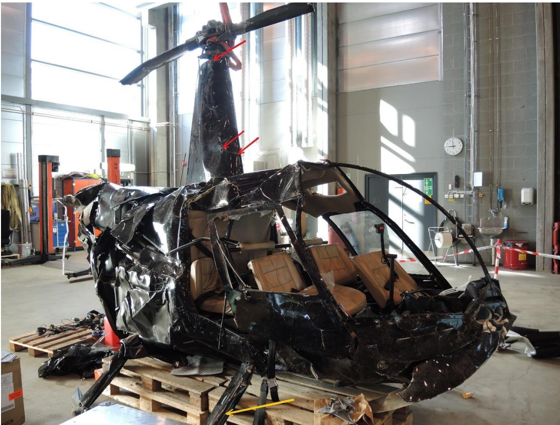
Figur 9: Skadene på helikopterets høyre side fotografert i Havarikommisjonens hangar. Røde piler peker på områder med smeltet aluminium. Gul pil peker mot skrapemerker på høyre fremre undersellslegg. Foto: SHK
