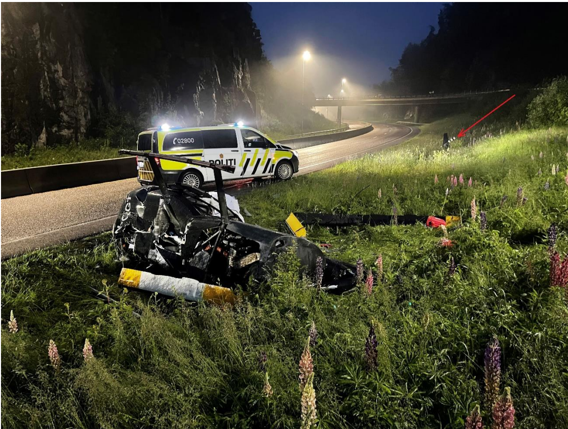
Figur 8: Helikopteret sett mot sørøst. Rød pil peker mot halerotoren. Foto: SHK
