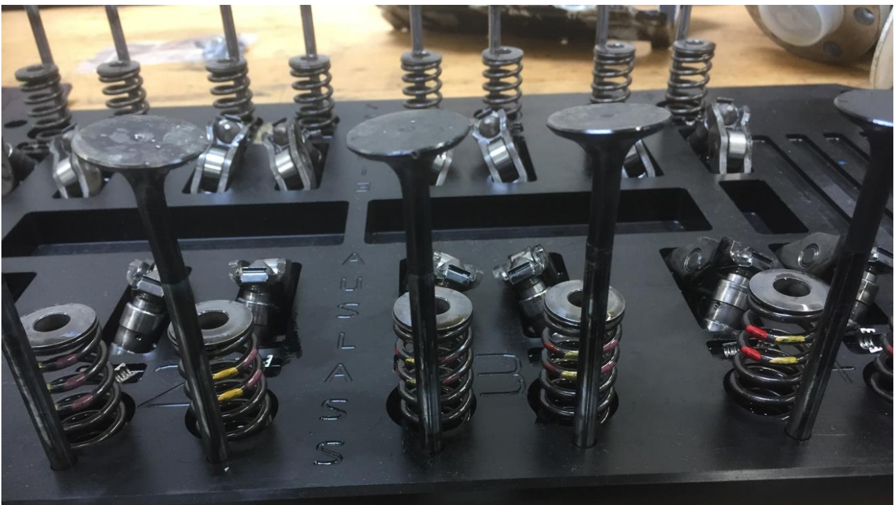
Figur 11: Eksosventiler fra sylinder 2 og 3 med bøyd stammer. Foto: Havarikommisjonen
