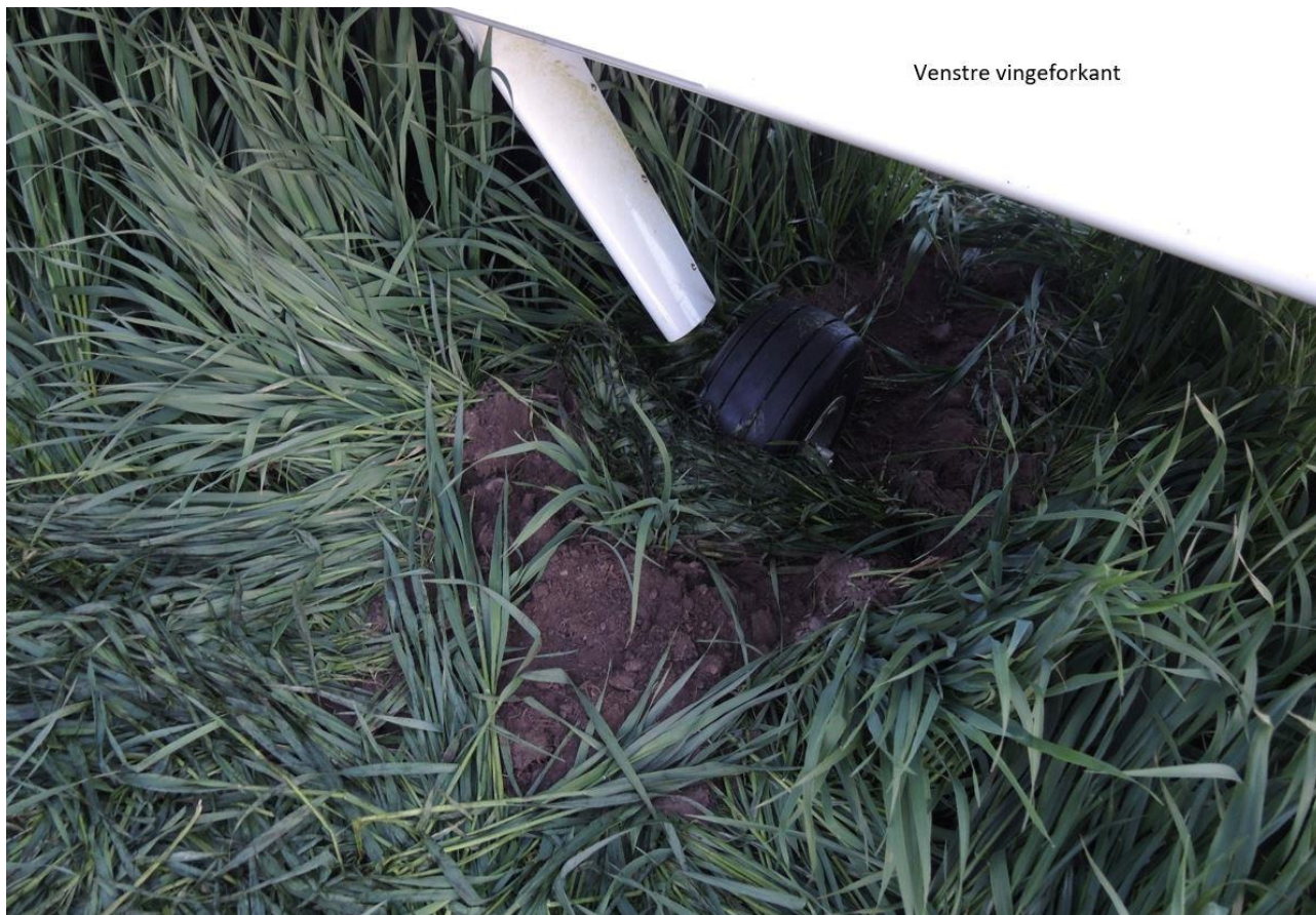
Figur 7: Dype spor i underlaget fra venstre hovedhjul. Foto: Havarikommisjonen
