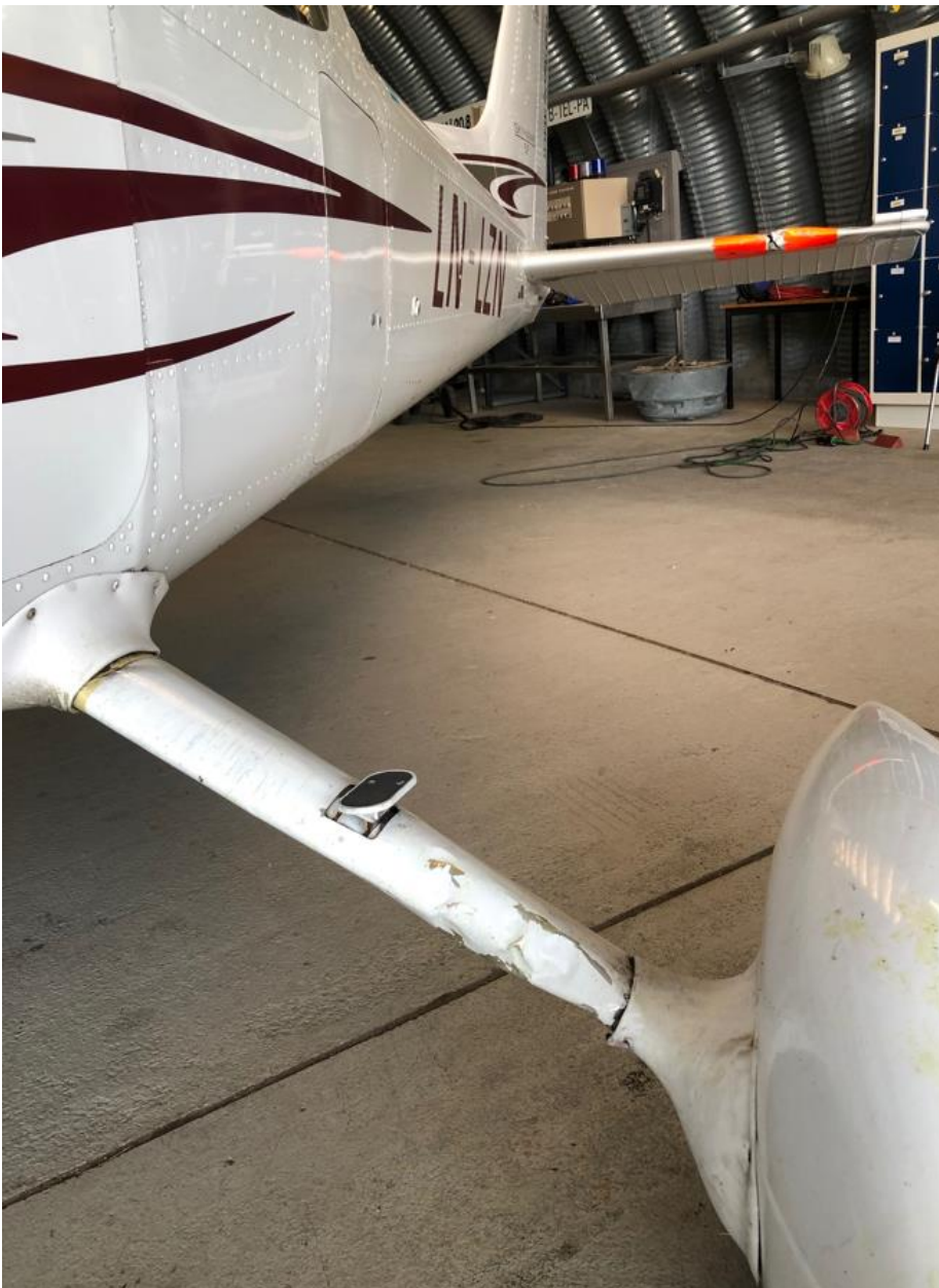
Figur 2: Skader på venstre hovedhjulslegg og haleflate. Foto: Fartøysjef LN-LZN
