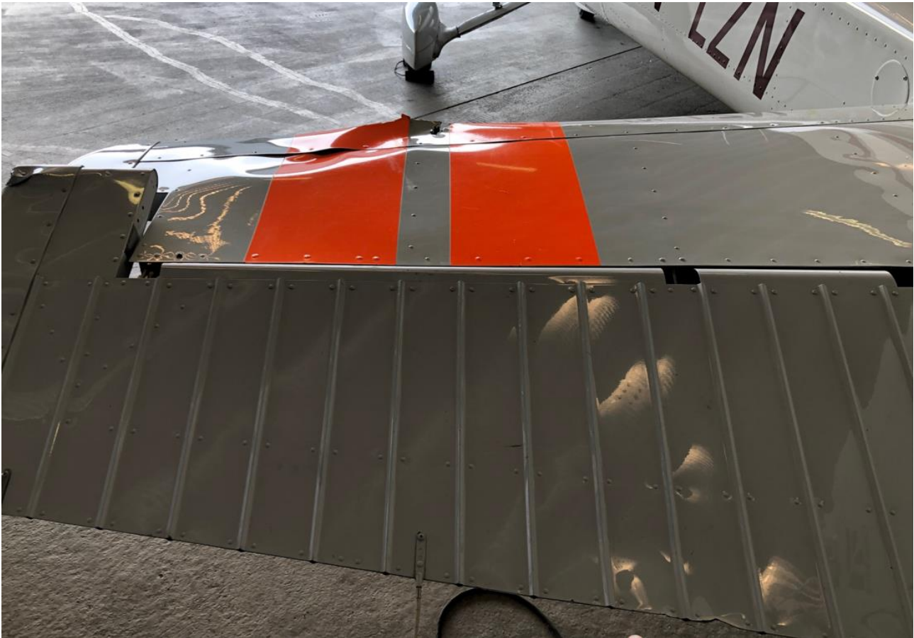
Figur 3: Skader på venstre haleflate og høyderor. Foto: Fartøysjef LN-LZN
