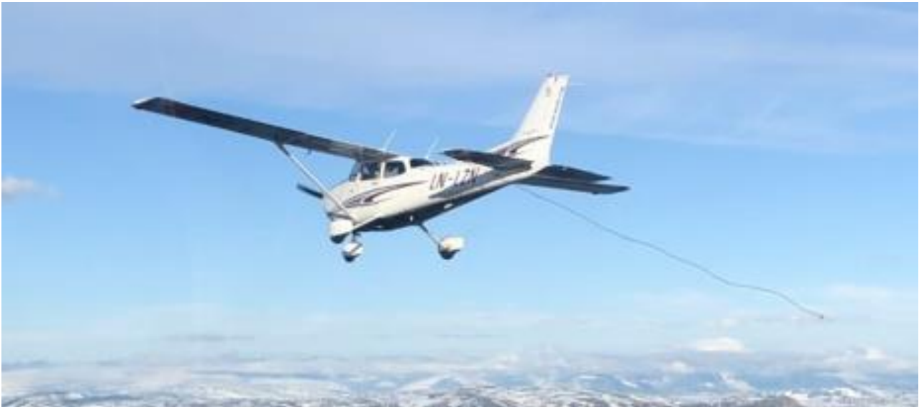
Figur 1: Piggtråden festet til venstre haleflate på LN-LZN vises tydelig på foto tatt fra følgefly LN-RED.
