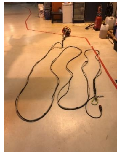
Figur 8: Lasteline med tilkoblet krok av samme type som ved hendelsen. Foto: Helitrans AS/SHK
