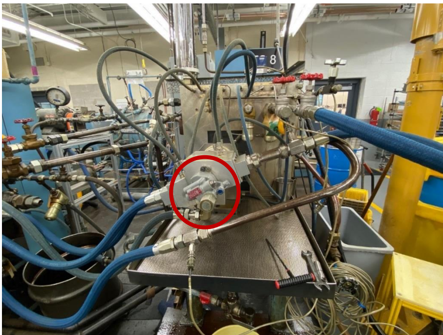
Figur 9: Oljepumpen fra LN-ONH i testapparatet. Pumpen er markert i rød ring. Foto: Crane Aerospace / SHK
