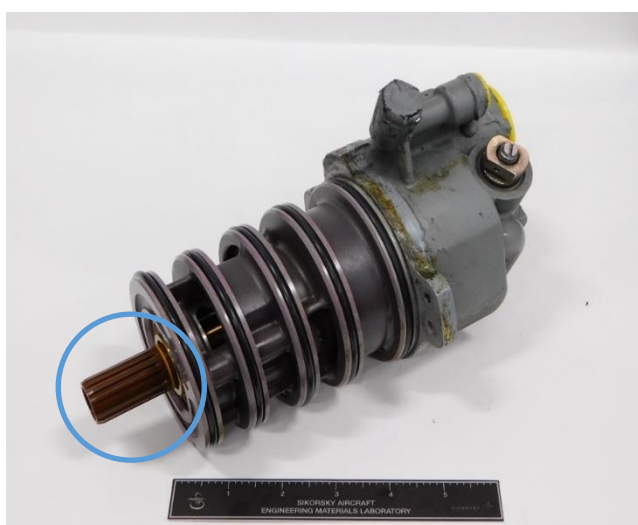
Figur 3: Oljepumpen. Vespel spline-koblingen er markert med ring. Foto: Sikorsky/SHK
