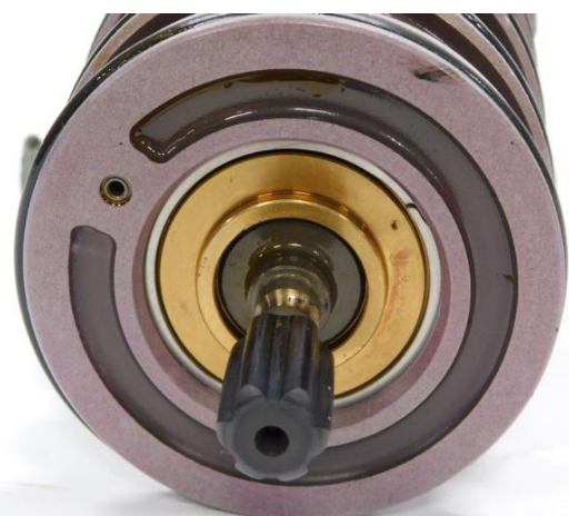
Figur 2: Illustrasjon av hvordan oljepumpen drives. Illustrasjon: Sikorsky/SHK
