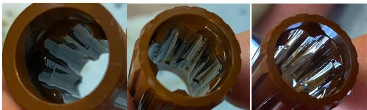
Figur 8: De to utmonterte Vespele spline-koblingene. Spline-kobling nummer 1 er helt nedslitt innvendig. Slitasje kan også sees på spline-kobling nummer 2. Foto: Bristow Norway AS / SHK
