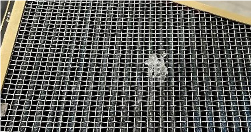
Figur 14: Bildet viser oppbygning av is på undersiden av IBF-filteret. Foto: Airbus Helicopters / SHK
