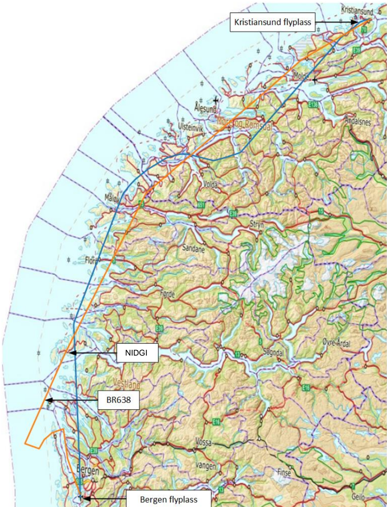
Figur 1: Ruten til WF577. Oransje strek viser planlagt rute, mens blå strek viser faktisk fløyet rute. Kart: © Kartverket. Illustrasjon: SHK
