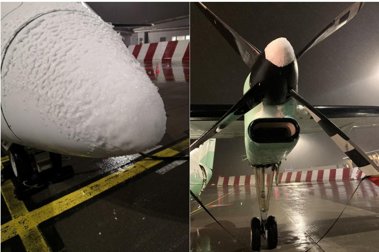
Figur 4: Gjenværende is på nese, spinner og området mellom luftinntak og spinner. Isen har blitt hengende til tross for at det var 8 °C og regn på flyplassen. Foto: Fartøysjef WF577
