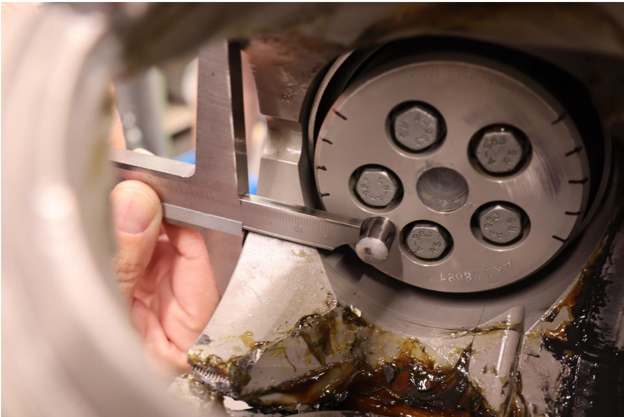
Figur 29: Måling av avstand mellom bladenes styrepinner og framkanten på propellnavet. Foto: BFU/SHK
