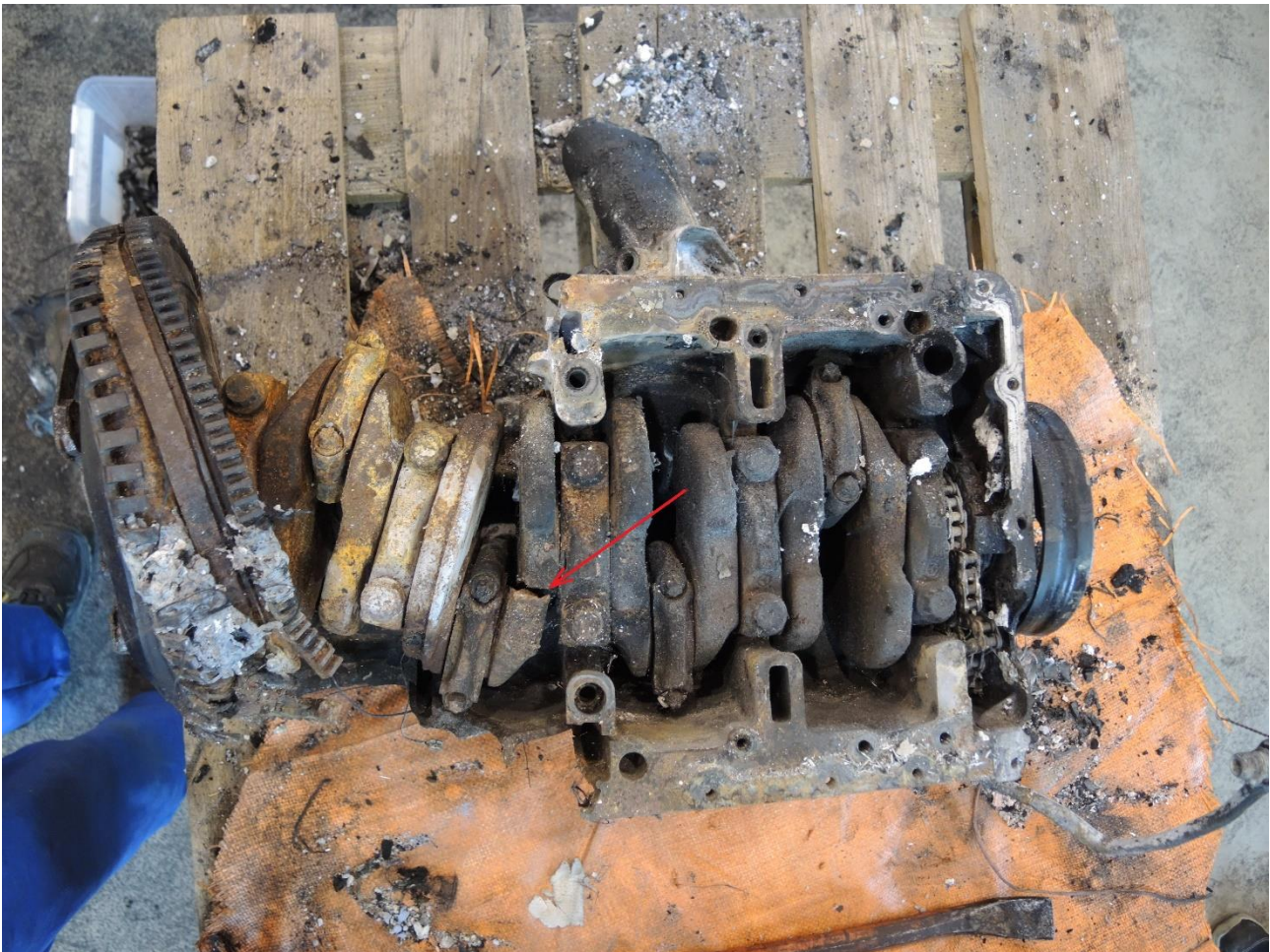
Figur 18: Skadene på venstre motor sett fra undersiden. Store deler av veivhuset er knust og mangler. Rød pil peker mot bruddet i veivakselen. Foto: SHK
