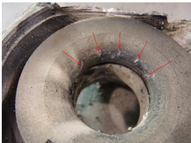
Figur 19: Kompressorhuset fra turboen til høyre motor. Pilene peker mot skader i huset etter kontakt med kompressor-rotoren. Foto: SHK
