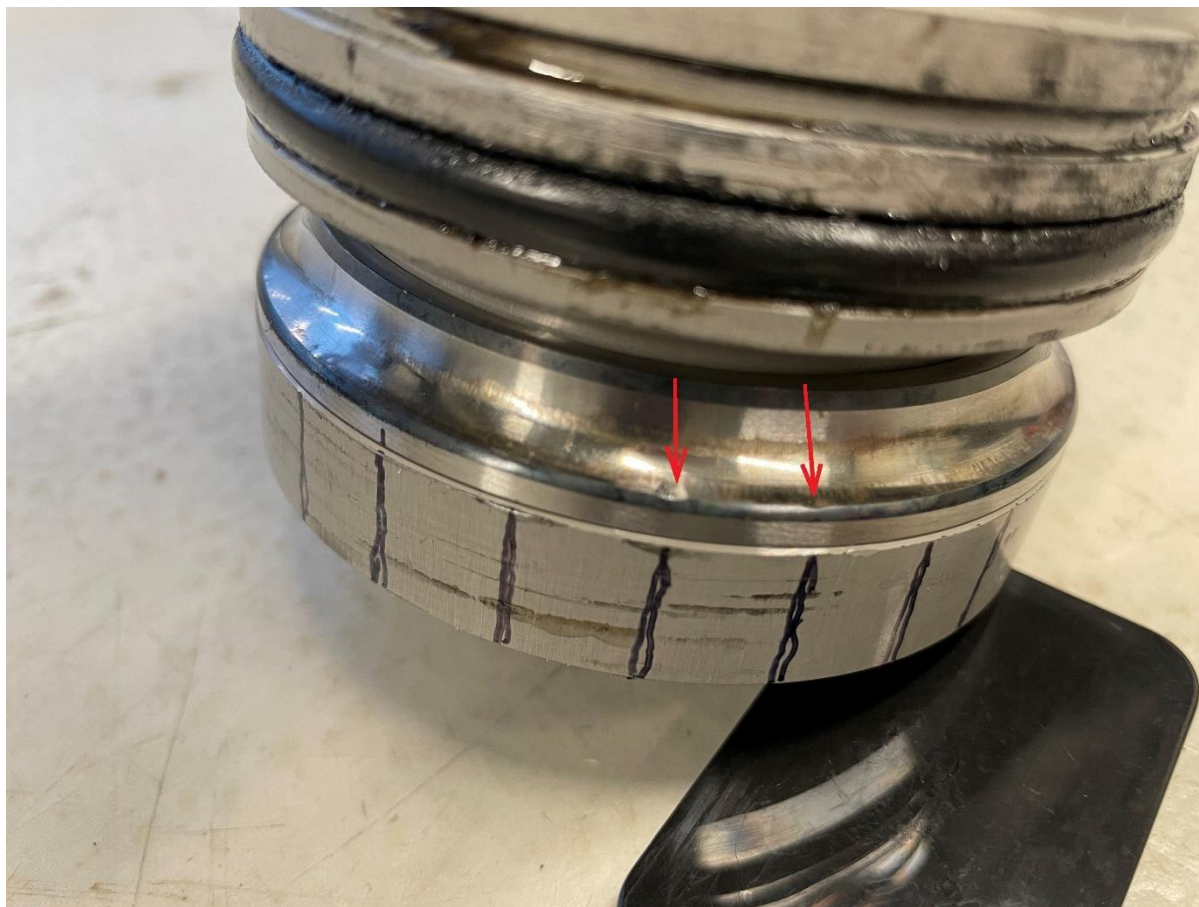
Figur 27: Bilde av bladroten til blad 1 etter at posisjonen på skadene er markert med sorte tusjstreker. To skader som kan sees på bildet er merket med rød pil. Foto: SHK
