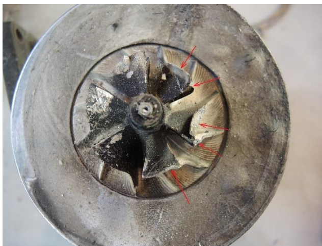
Figur 20: Kompressor-rotoren fra turboen til høyre motor. Pilene peker mot bøyde rotorblader. Foto: SHK
