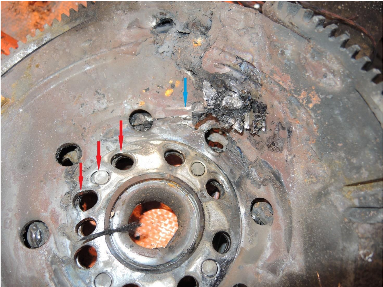
Figur 22: Baksiden av svinghjulet på høyre motor. En ripe er markert med blå pil. Flere ovale bolthull er markert med røde piler. Foto: SHK
