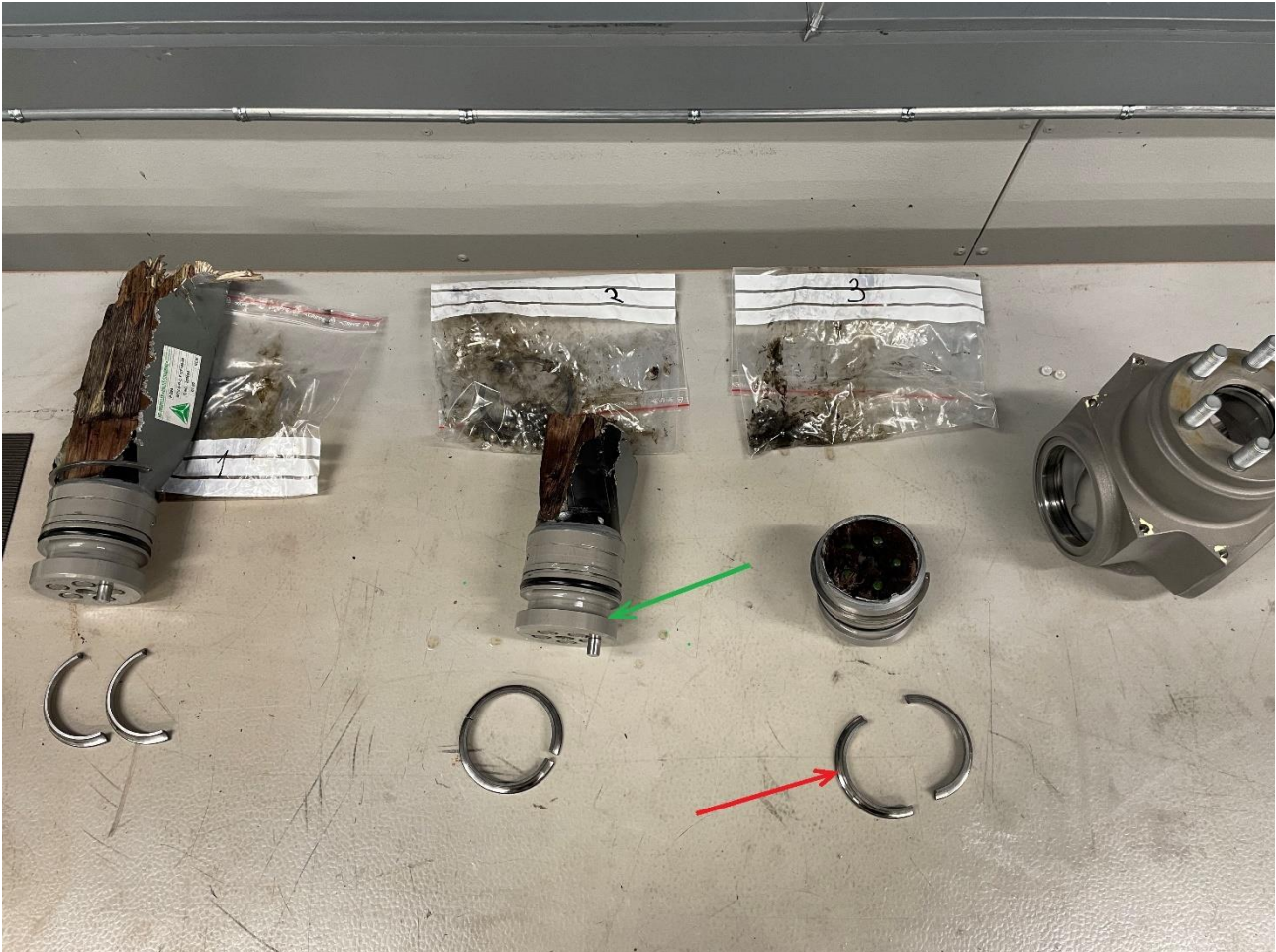
Figur 26: De tre bladrøttene fra høyre propell (blad 1 til venstre) og propellnavet helt til høyre. Rød pil peker mot de to halve lagerbanene som satt på blad 3. Grønn pil peker mot stedet på bladrøttene hvor lagerbanene skal sitte. Foto SHK
