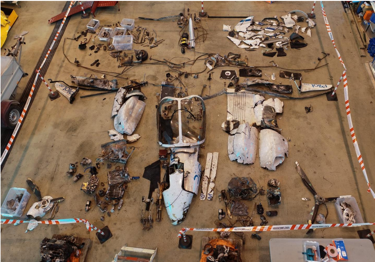
Figur 13: Delene fra flyet lagt ut i tilnærmet riktig innbyrdes posisjon sett forfra. Venstre vinge er til høyre på bildet. Motorene ligger på paller nederst i bildet. Foto: SHK
