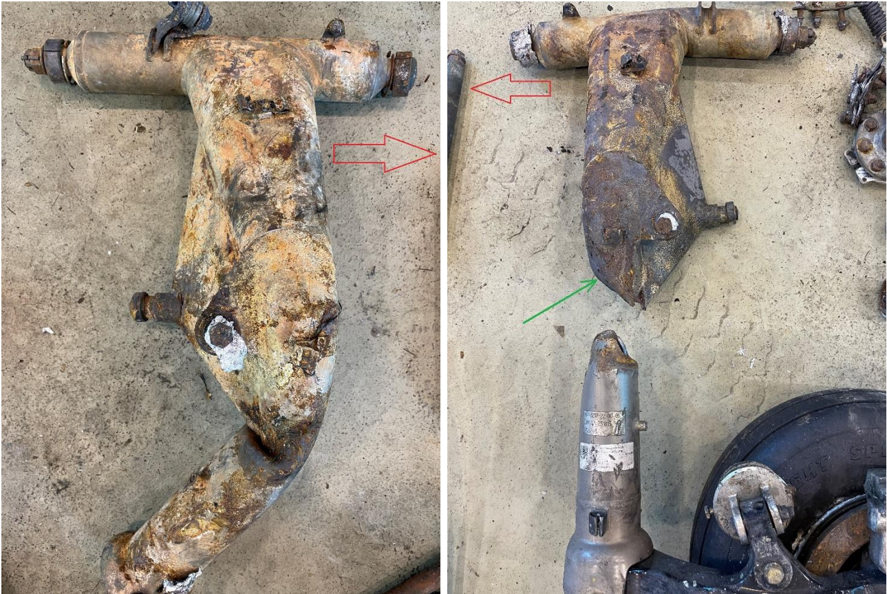
Figur 14: Venstre understell til venstre og høyre understell til høyre. Røde piler viser flygeretningen. Begge understellene er slått bakover. Det høyre understellet er slått av og den øvre delen av leggen er i tillegg slått inn fra forsiden etter at bruddet oppsto (se grønn pil). Foto: SHK
