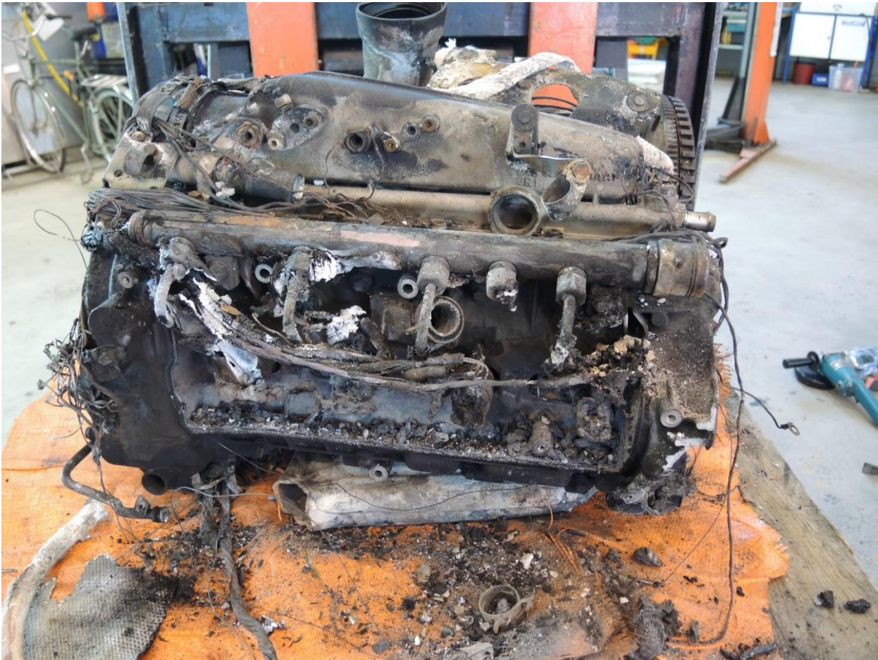
Figur 17: Venstre motor før demontering. Foto: SHK
