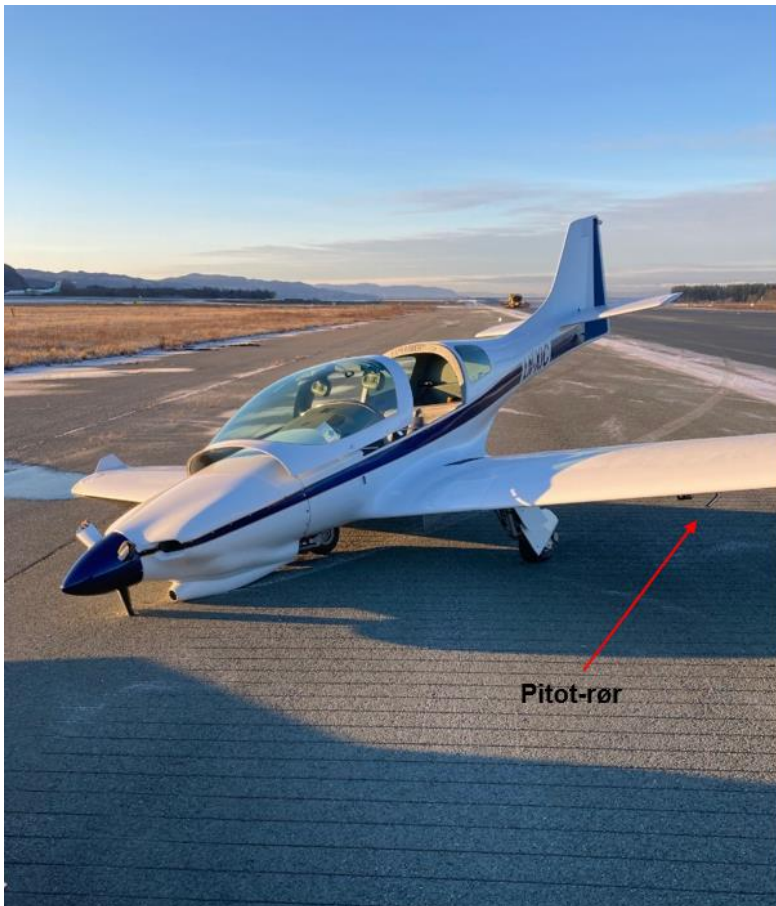
Figur 2: LN-XIC på rullebaneskulderen ved avkjøring A6. På bildet kan man se pitot-røret montert under venstre ving. Neshjulsleggen og høyre hovedhjulslegg har kollapset. Alle tre propellbladene er slått av. Det er drivstofflekkasje fra høyre vingetank. Foto: Flygeren/SHK
