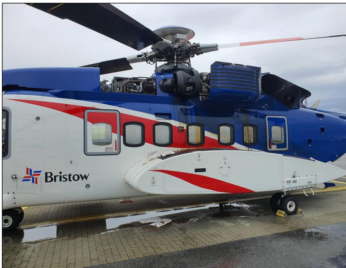
Figur 3: LN-ONQ kort tid etter landingen. Synlig oljesøl på skrogets venstre side og dekslene er åpnet rundt venstre motor og hovedgirboksen. Foto: Bristow Norway/SHK
