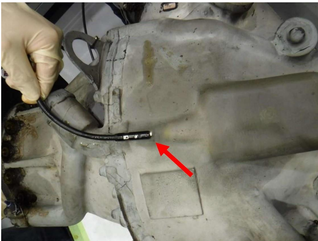
Figur 12: Venstre input module sett fra undersiden. Innfestingen til main gearbox module er til venstre på bildet. Enden på boroskopet (det fleksible inspeksjonsutstyret) er lagt over oljekanalene som ble fulgt inn til skiven. Rød pil angir hvor skiven ble funnet. Foto: NTSB/SHK
