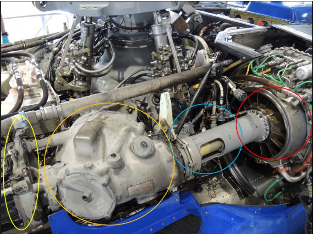
Figur 6: LN-ONQ fotografert dagen etter hendelsen. Venstre accessory module (helt til venstre i bildet, gul sirkel) og venstre input module (midt på bildet, oransje sirkel). Drivakselen (blå sirkel) og fronten på venstre motor (rød sirkel) sees til høyre i bildet. Foto: SHK
