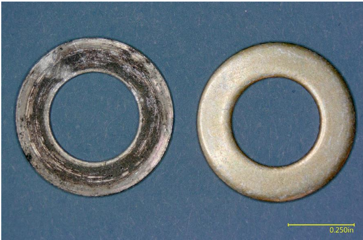
Figur 14: Skiven som ble funnet i hovedgirboksen til venstre og referanseskiven til høyre. Foto: NTSB/SHK
