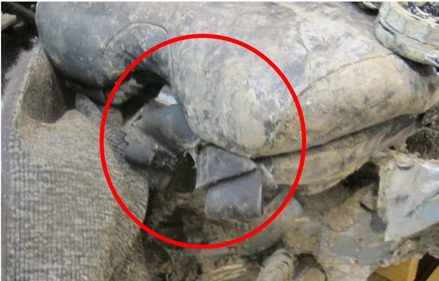
Figur 11: En av fem stropper til setebeltet foran ble funnet sammenrullet under setet etter ulykken. Foto: SHK
