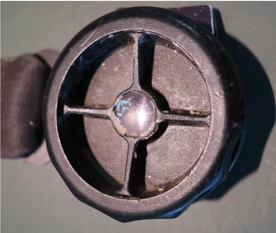
Figur 20: Den intakte festemekanismen til flygerens belte for å illustrere hvordan en intakt festemekanisme ser ut. Man vrir på ringen for å løse ut spennene. En av spennene sitter alltid fast. Foto: SHK
