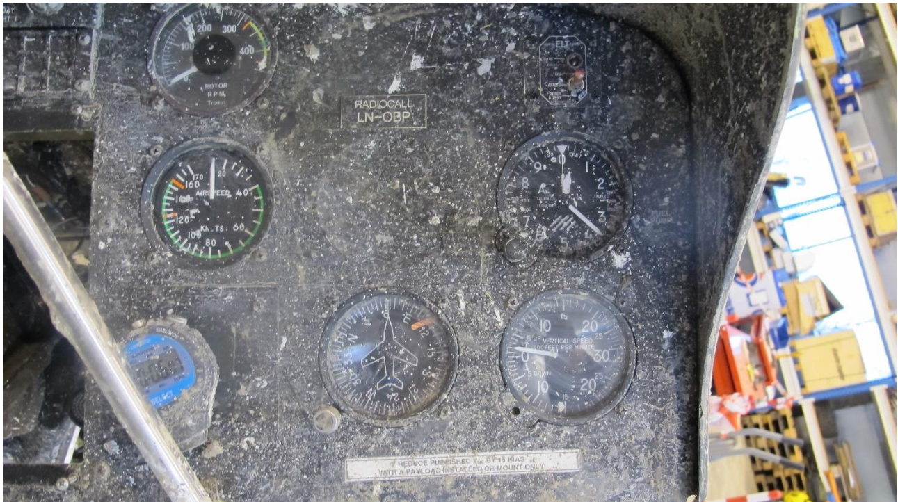
Figur 8: Den kunstige horisonten skulle vært montert under skiltet «radiocall LN-OBP». Hullet etter instrumentet var dekket med elektrikkerteip. Foto: SHK
