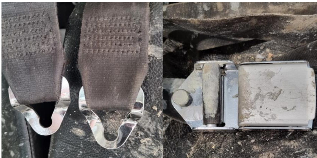
Figur 19: Foto av sikkerhetsbeltet til passasjerer bak. Det er ingen tegn til maling på skulderstroppen, mens mye maling sees på hoftebeltet. Begge skulderstroppene som er festet sammen bak ble undersøkt for å se om passasjerer hadde benyttet feil skulderstropp. Foto: SHK
